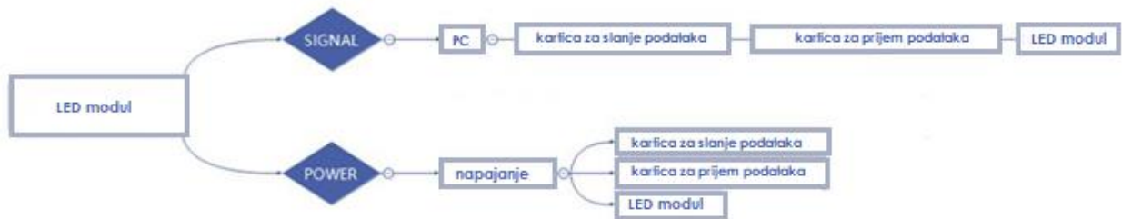
Slika 3.13. Dijagram ožičenja LED zaslona [12]
