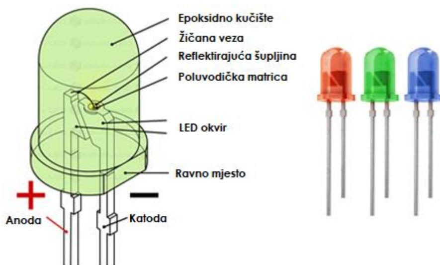
Slika 3.4. Diode s DIP kapsulacijom [10]
