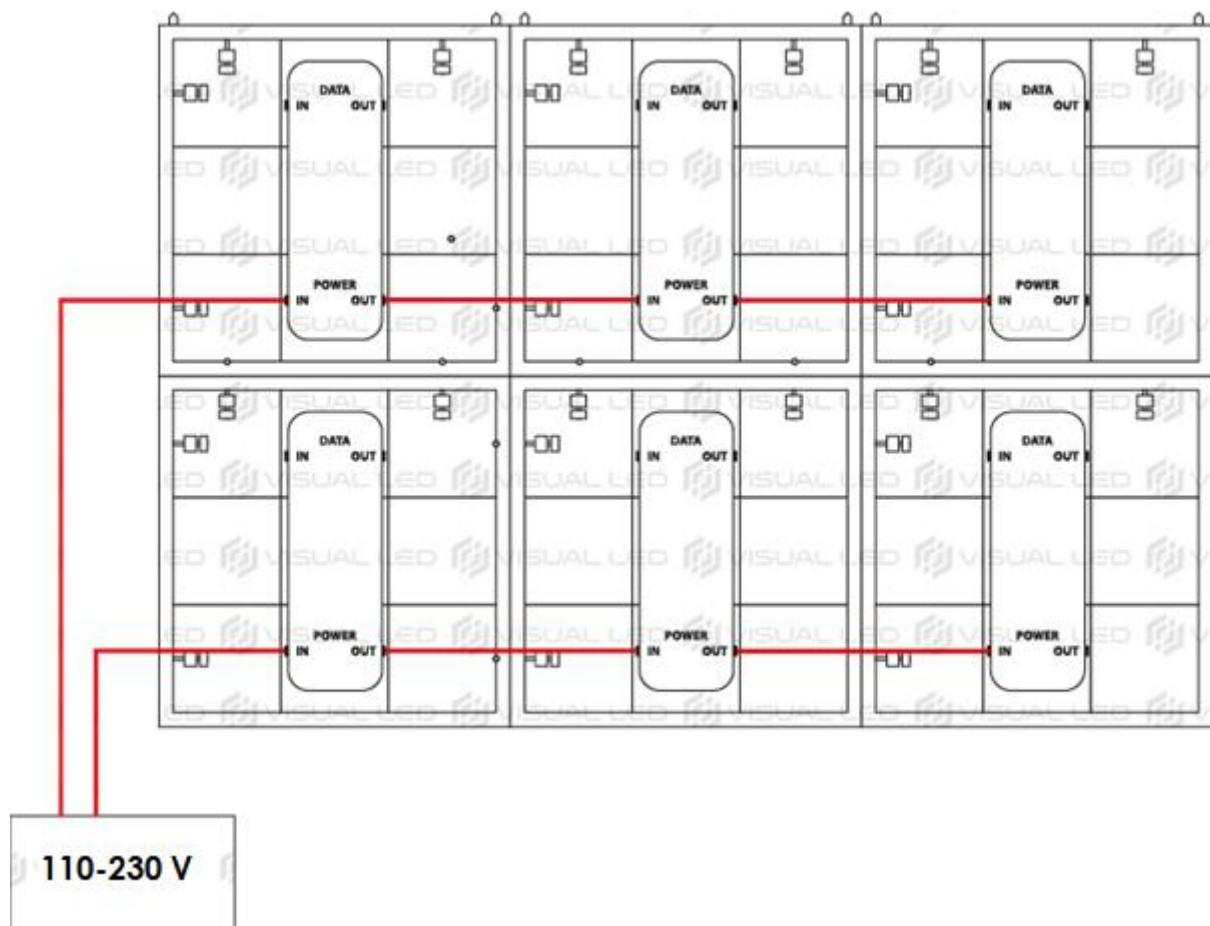
Slika 3.16. Dijagram povezivanja napajanja - priključci [10]
