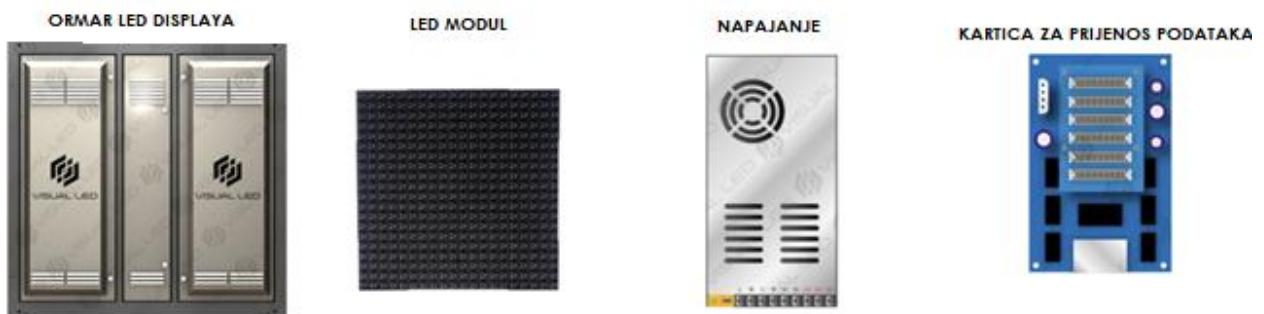
Slika 3.7. Dijelovi LED zaslona [10]
