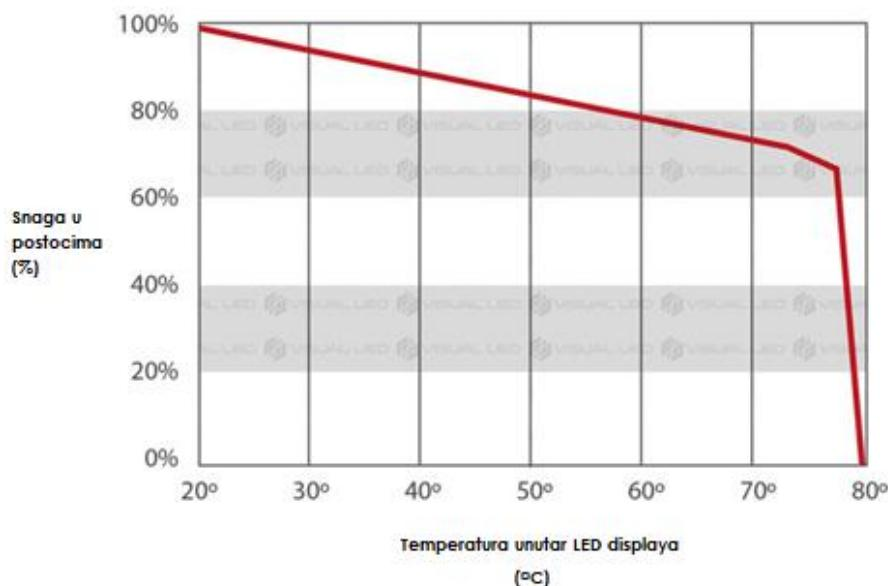
Slika 3.2. Graf ovisnosti snage LED zaslona o temperaturi [10]
