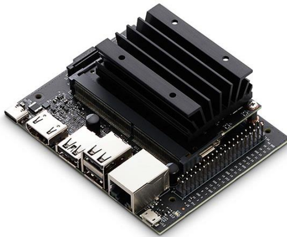
Slika 4.6. Nvidia Jetson Nano
