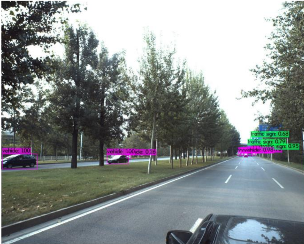
Slika 5.2. Objekti koje je detektirao YOLOv3 pokrenut na računalu detektirao na tri primjera slika Apolloscape skupa.
