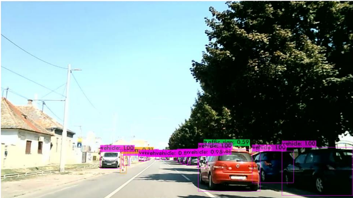
Slika 5.2. Objekti koje je detektirao YOLOv3 pokrenut na računalu detektirao na tri primjera slika Apolloscape skupa.
