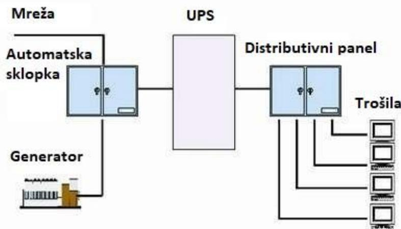
Slika 6.1. Blokovski prikaz kombiniranog sustava za besprekidno napajanje [19]
