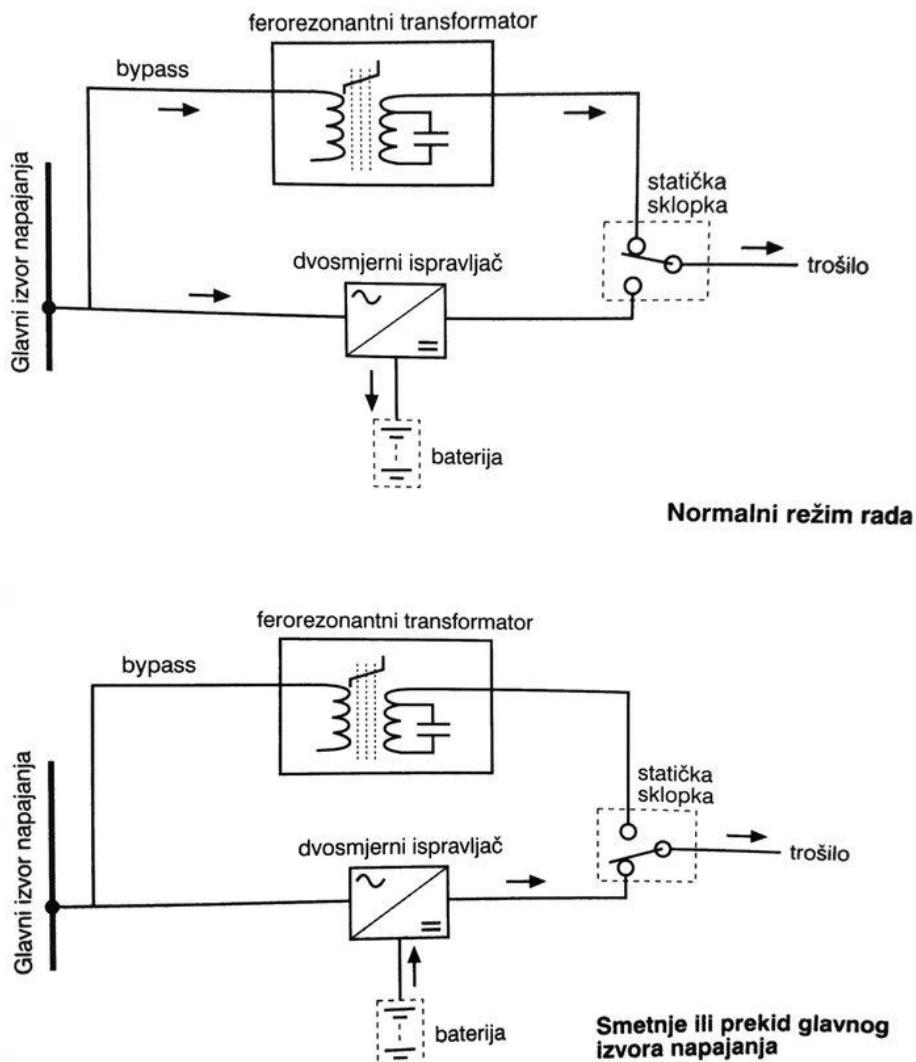
Slika 4.14. Topologija linijsko interaktivnog UPS-a s ferorezonantnim transformatorom [1]
