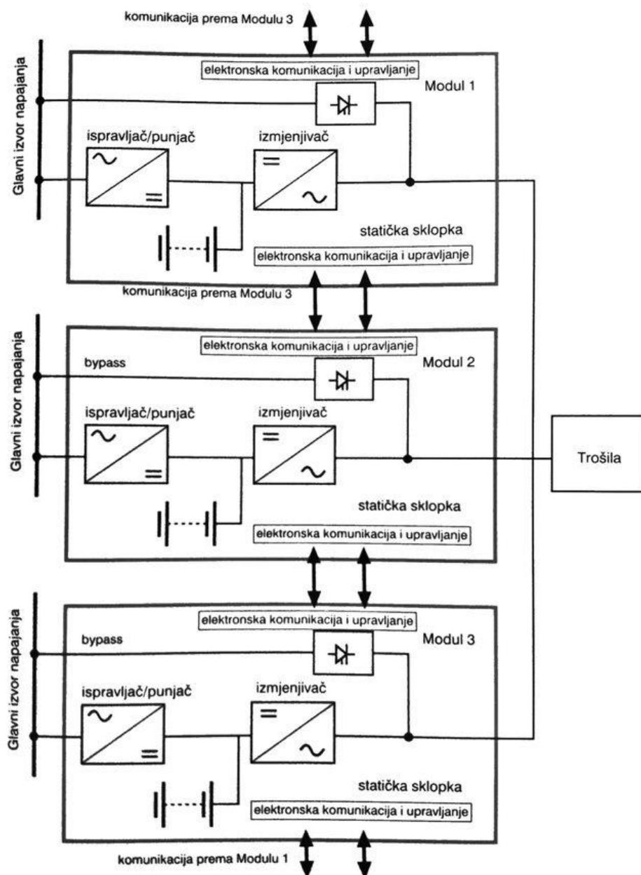
Slika 4.16. UPS uređaji u paralelnom radu [1]
