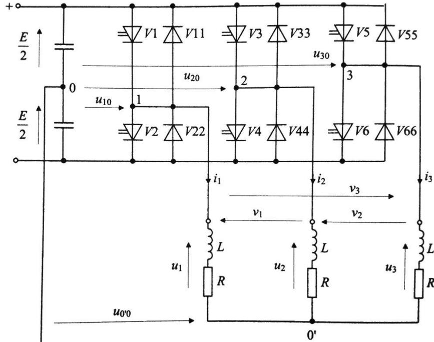
Slika 4.7. Shema izmjenjivača u trofaznom mosnom spoju [3]
