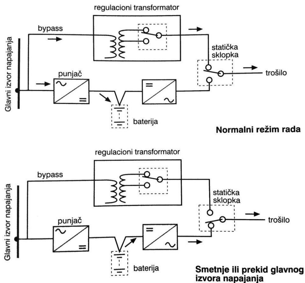
Slika 4.13. Topologija linijsko interaktivnog UPS-a s regulacionim transformatorom [1]
