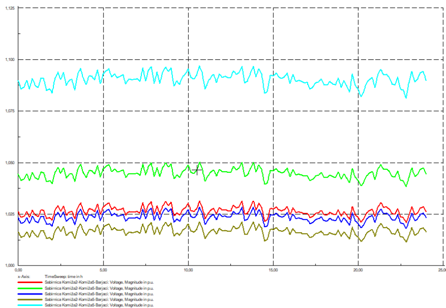
Slika 4.51. Promjena razine napona na sabirnici postrojenja na morske valove uslijed promjene snage kratkog spoja mreže
