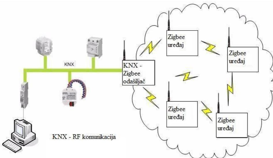
Slika 3.1.2 KNX radio frekvencijski prijenos [14]
