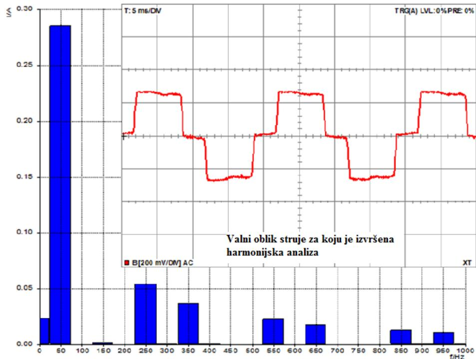
Slika 6.19. Harmonijska analiza fazne struje  $i_1$  sekundara transformatora u Yy6 spoju
