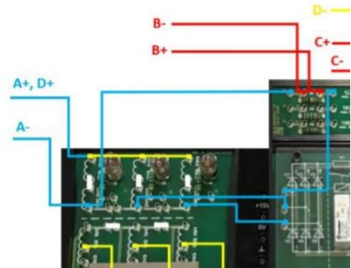
*Slika 2.6. Shematski prikaz spajanja grupe spoja Yy6*
