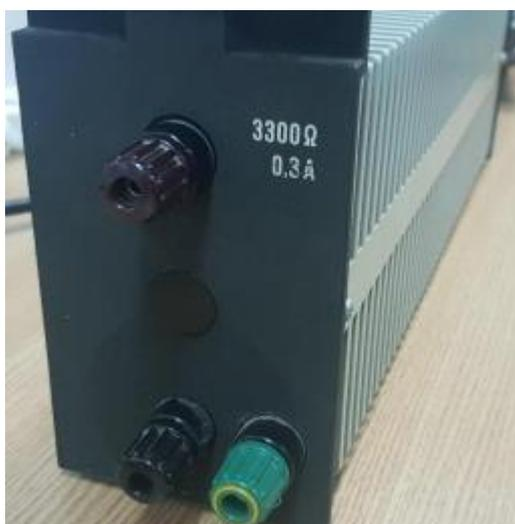
*Slika 6.2. Promjenjivi otpornik*
