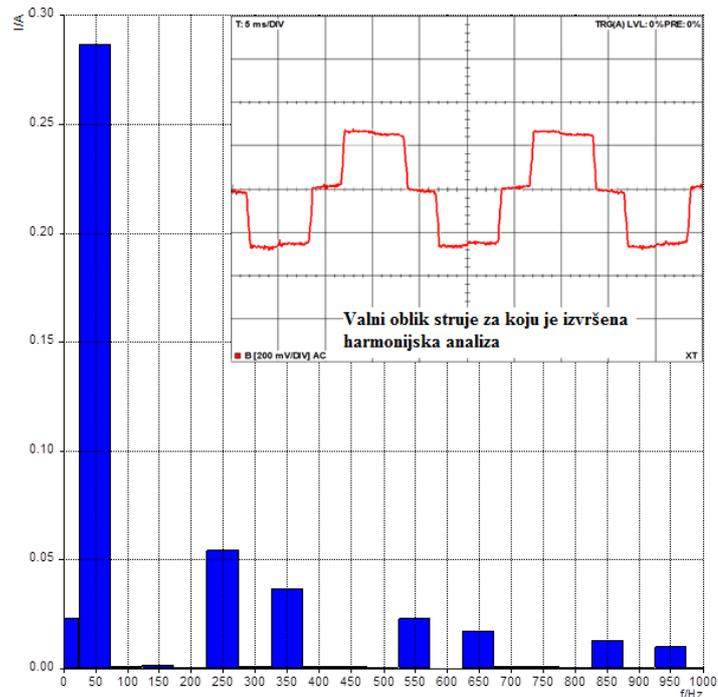
**Slika 6.10.** Harmonijska analiza fazne struje  $i_1$  sekundara transformatora u  $Yy0$  spoju
