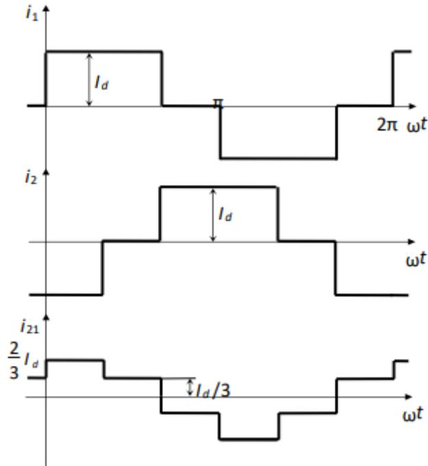
*Slika 5.4. Karakteristični valni oblici struje za trokut spoj*
