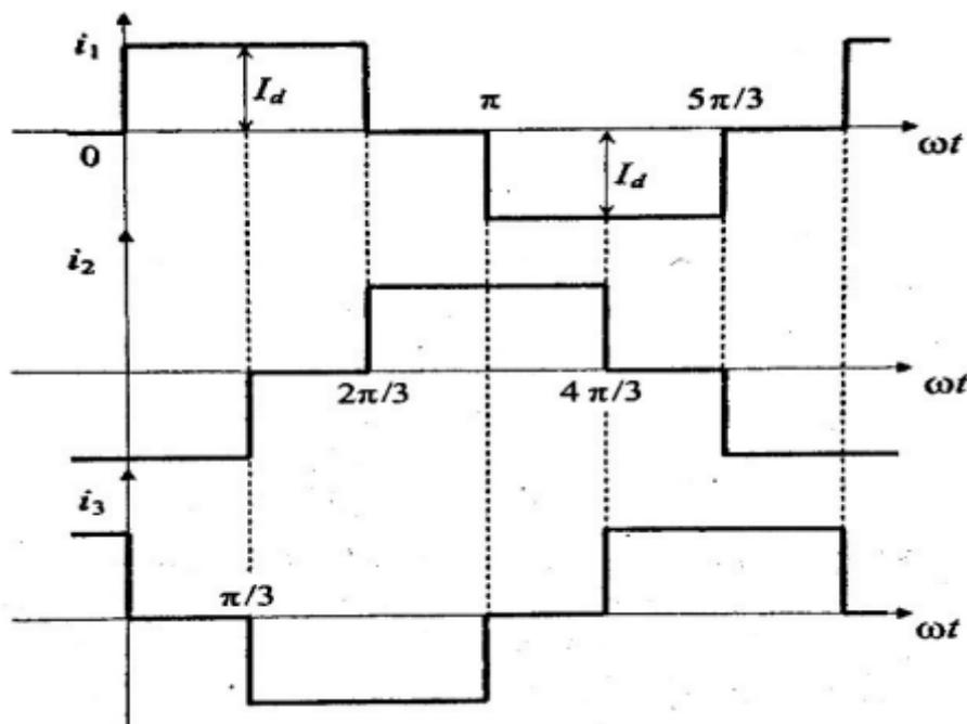
Slika 5.2. Karakteristični valni oblici struja za zvijezda spoj
