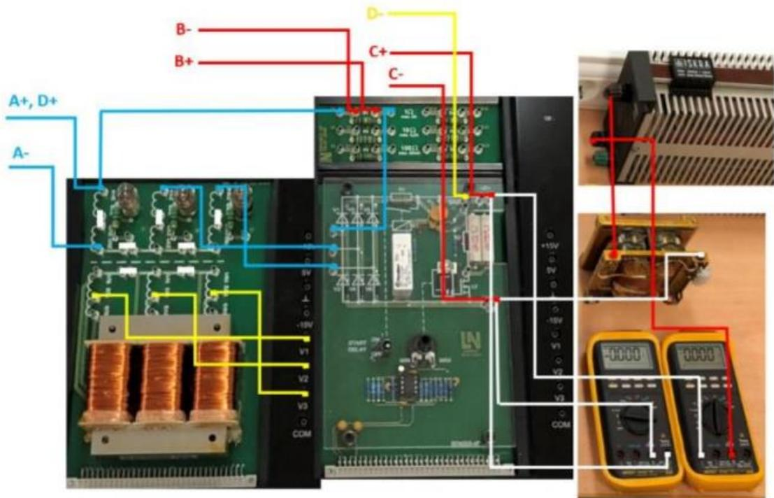
*Slika 6.7. Shematski prikaz spajanja Yy0 grupe spoja*
