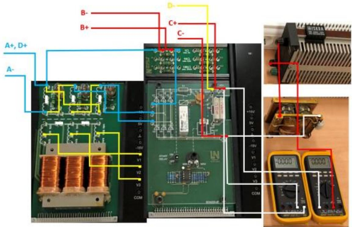
*Slika 6.11. Shematski prikaz spajanja Yd0 grupe spoja*
