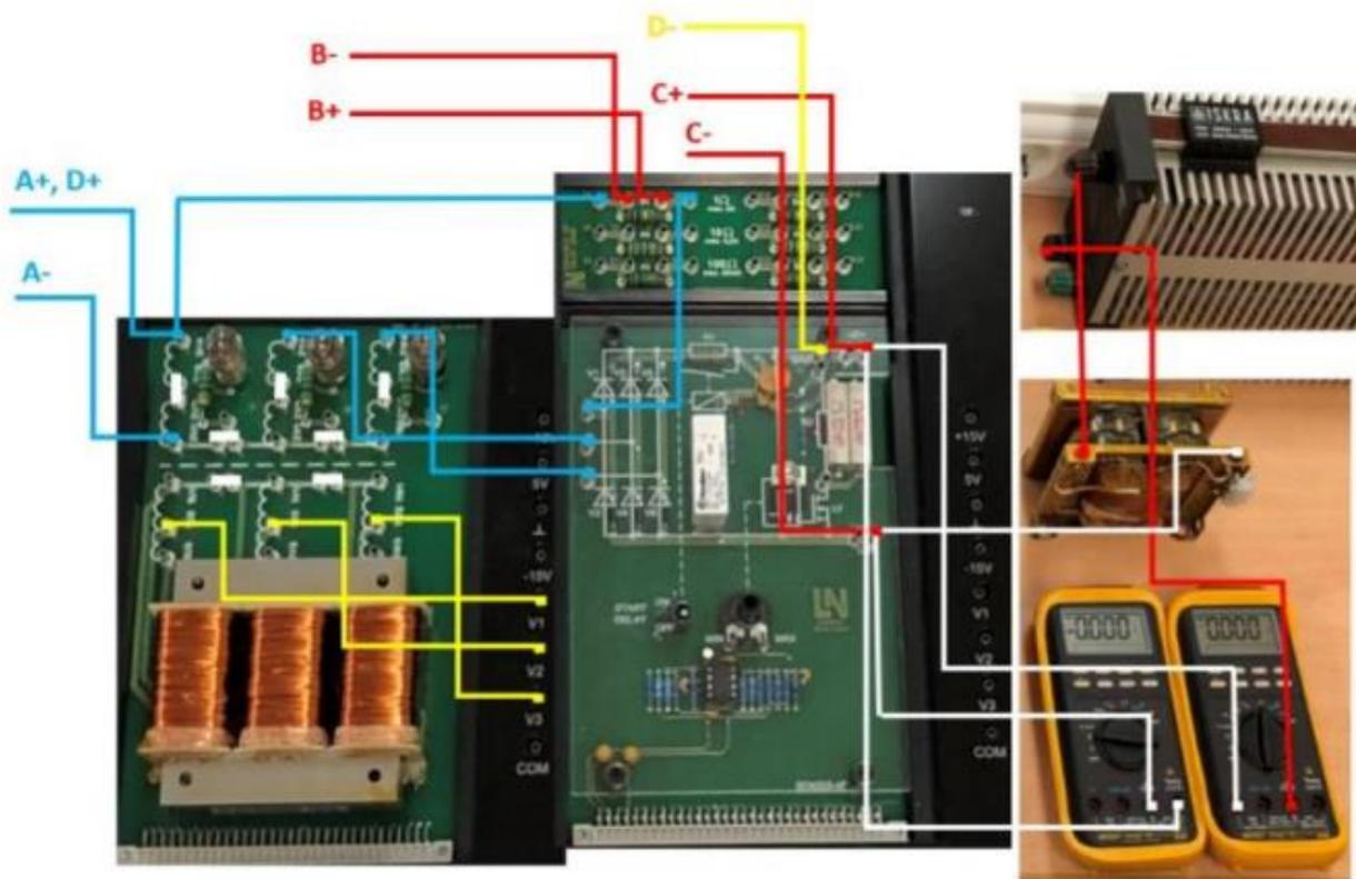
*Slika 2.1. Shematski prikaz spajanja Yy0 grupe spoja*
