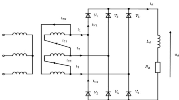
*Slika 1.3. Shema ispravljača spojenog na mrežu preko Yd0 grupe spoja transformatora*
