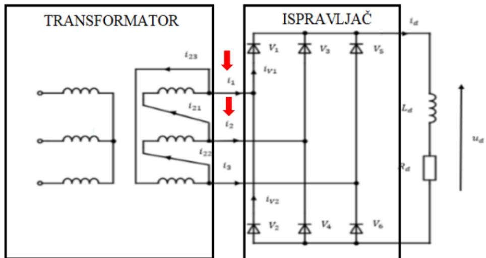
Slika 6.12. Shematski prikaz spoja ispravljača i transformatora u Yd0 spoju
