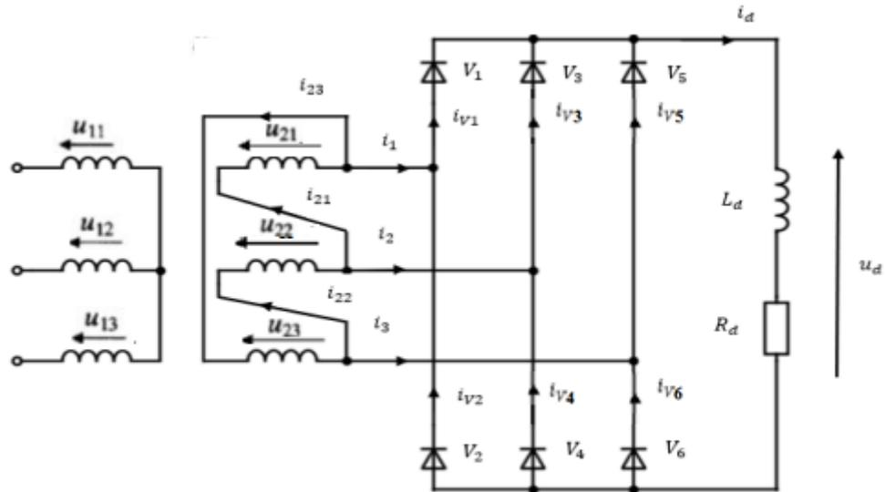
Slika 5.3. Shema ispravljača spojenog na mrežu preko Yd0 grupe spoja transformatora
