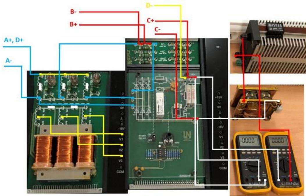
Slika 6.20. Shematski prikaz spajanja Yy10 grupe spoja
