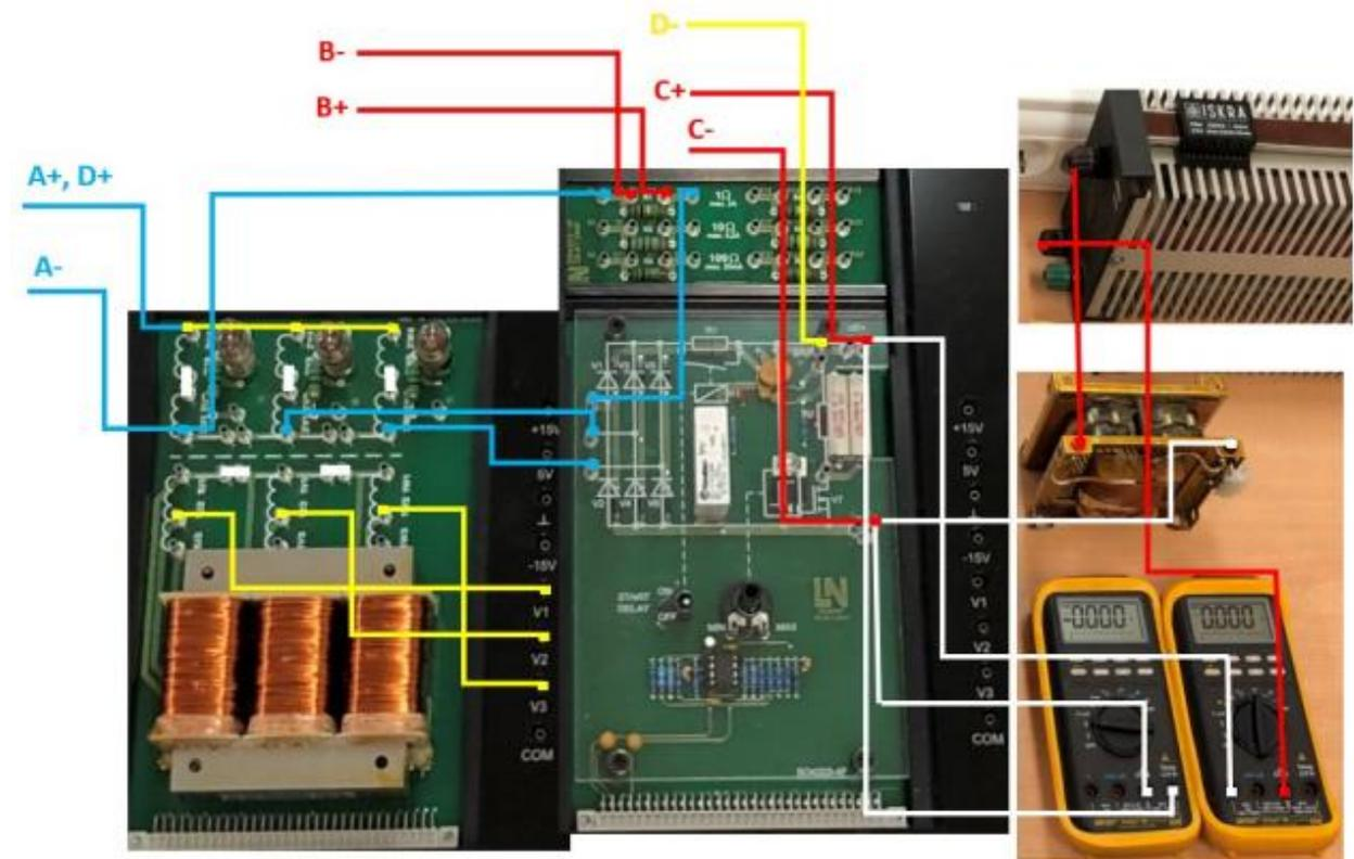
Slika 6.16. Shematski prikaz spajanja  $Yy6$  grupe spoja
