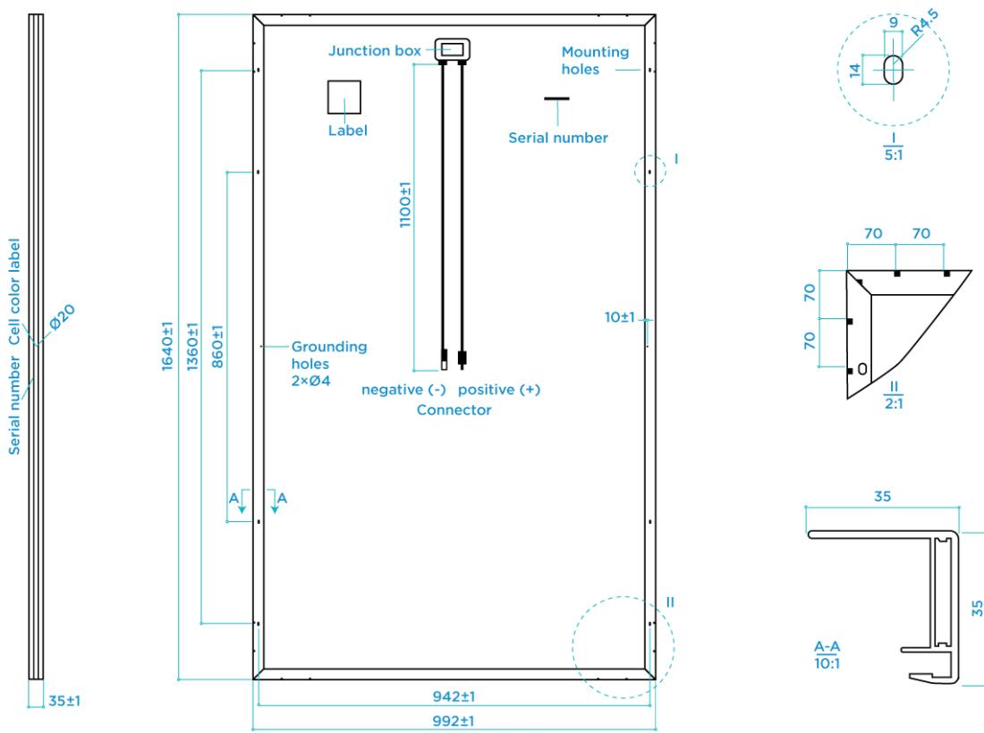
**Sl. 3.2. Dimenzije fotonaponskog modula [19]**
