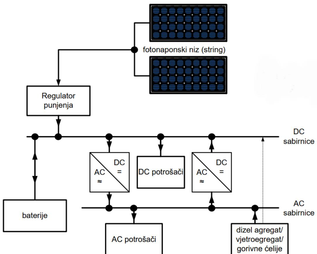
Sl. 2.10. Blok shema hibridnog fotonaponskog sustava [9]
