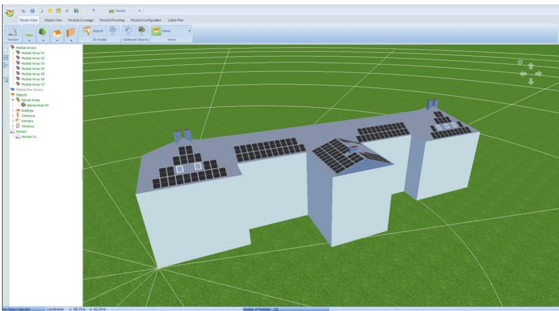
Sl. 3.11. Prikaz zgrade FERIT 2 s instaliranim fotonaponskom elektranom snage 40 kW
