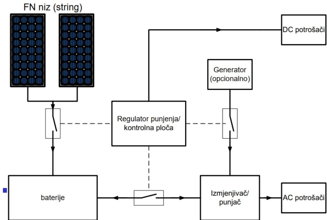
Sl. 2.9. Blok shema samostojećeg fotonaponskog sustava [9]
