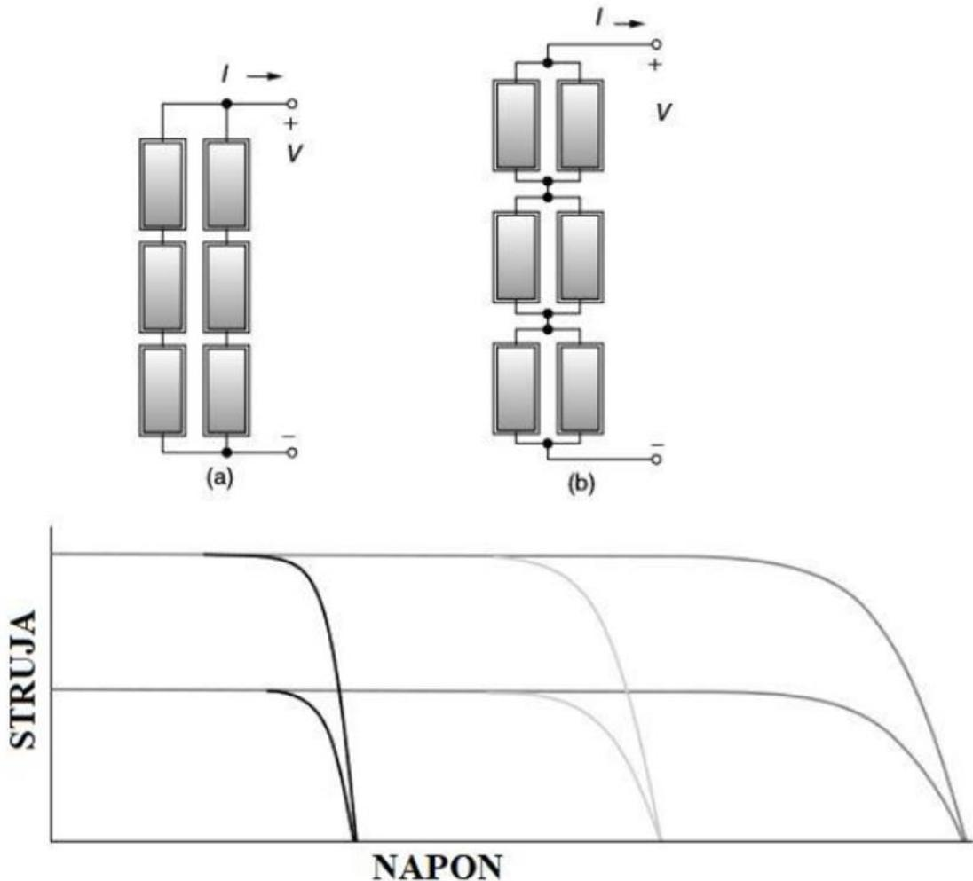
**Sl. 3.6.** Strujno naponske karakteristike različitih spojeva modula. [1]
