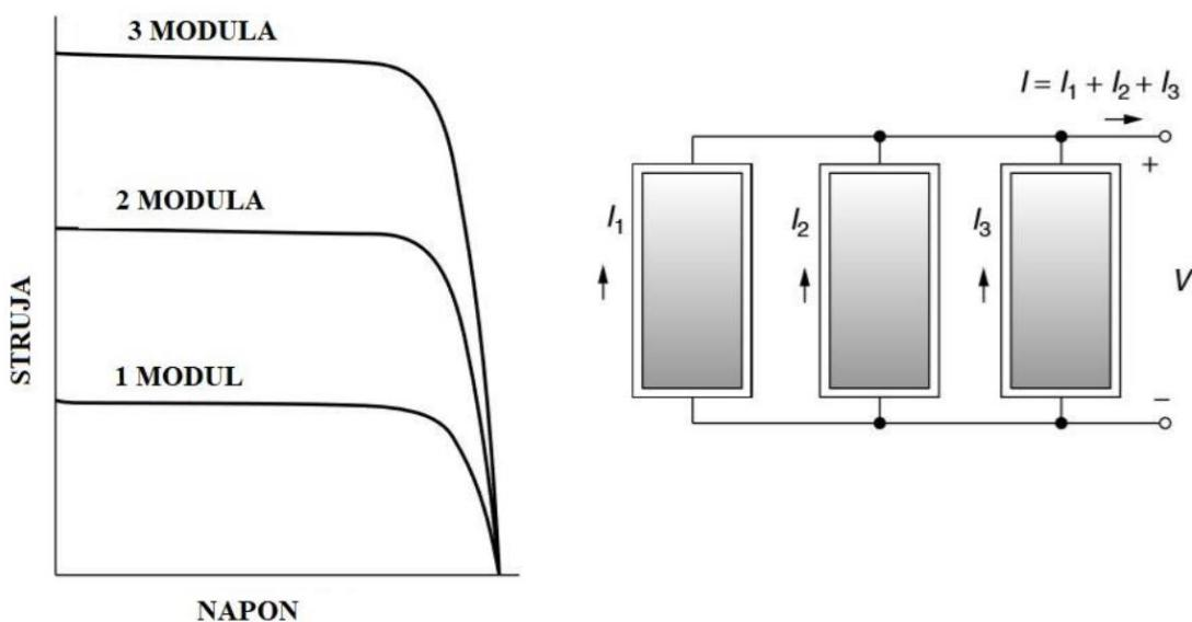
**Sl. 3.3.** Strujno-naponska karakteristika modula u paralelnom spoju. [1]
