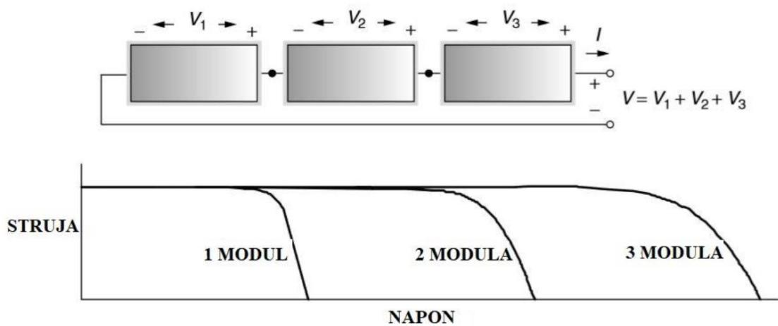
Sl. 3.4. Strujno-naponska karakteristika modula u serijskom spoju. [1]
