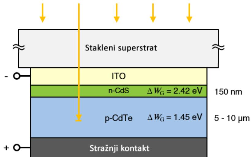
Sl. 2.4. Poprečni presjek tankoslojne ćelije Kadmij-Telurij [6]
