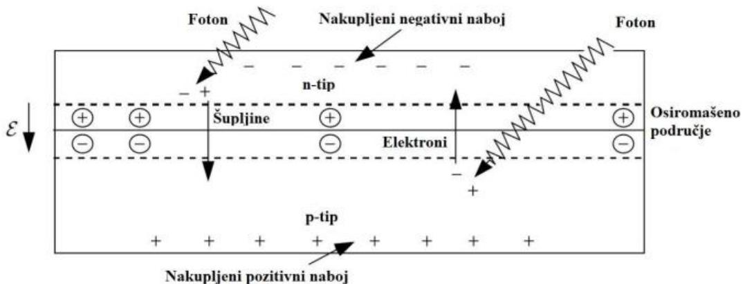
**Sl. 2.1.** Prikaz presjeka fotonaponske čelije [1]
