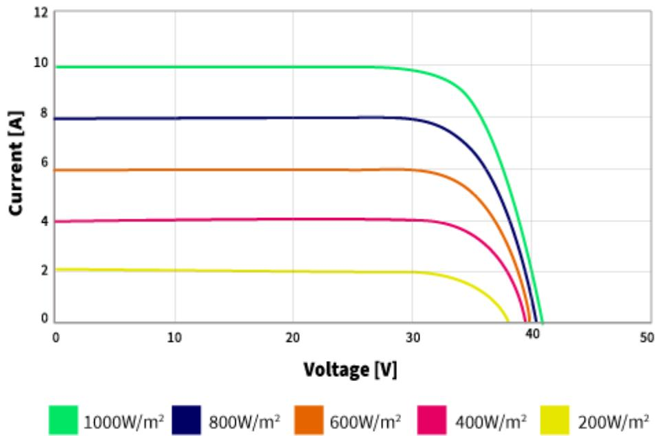
**Sl. 3.8.** I-U karakteristika fotonaponskog modula SEM 320W [19]
