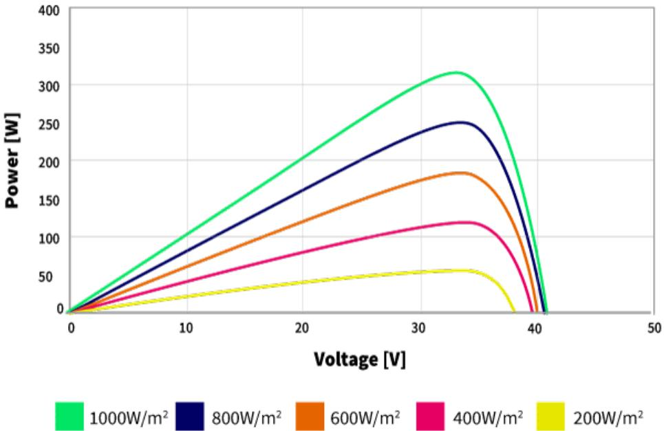
**Sl. 3.7.** P-V karakteristika fotonaponskog modula SEM 320W [19]
