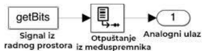
Sl. 5.4. Blok shema u Simulink-u za obradu izlaza iz VHDL-a kao digitalnog signala [12]
