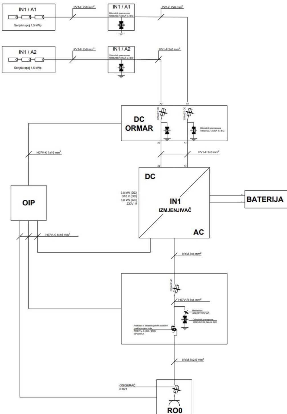
Slika 3.20. Shema spjanja fotonaponske elektrane snage 3 kW
