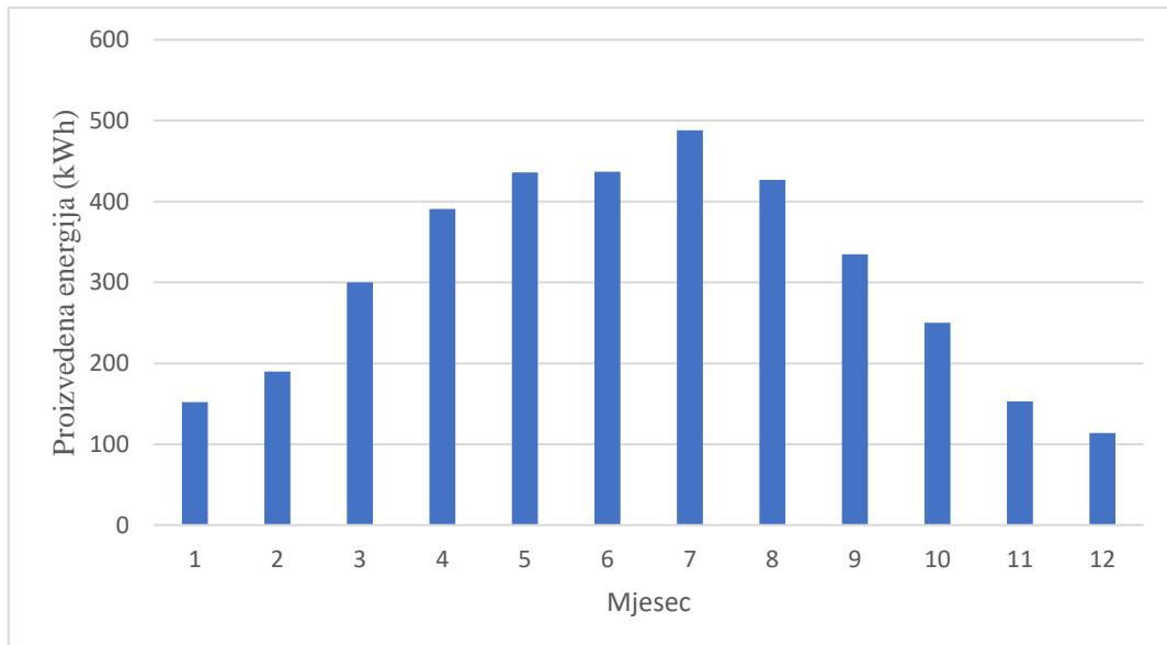
Slika 3.30. Očekivana proizvodnja fotonaponske elektrane snage 3 kW.
