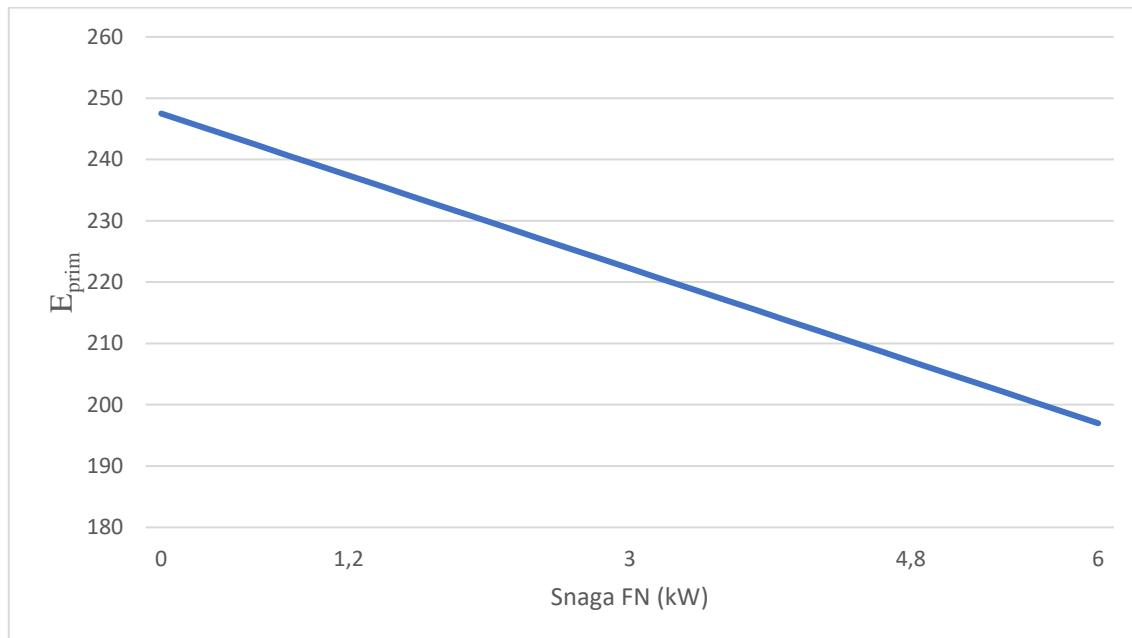
Slika 3.26. Utjecaj snage fotonaponske elektrane na  $E_{prim}$ .
