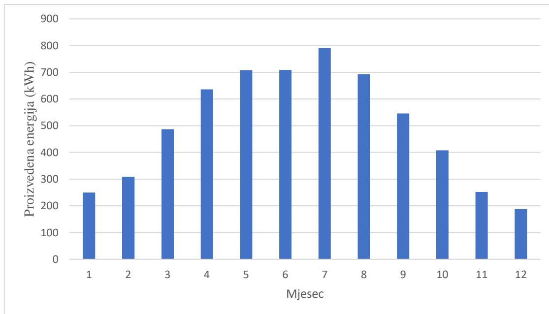
Slika 3.31. Očekivana proizvodnja fotonaponske elektrane snage 4,8 kW.
