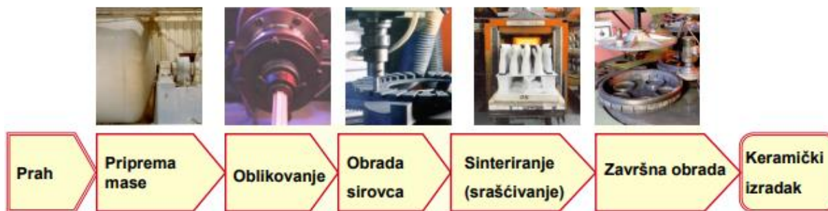
Sl. 3.6. Proces proizvodnje keramike [20].
