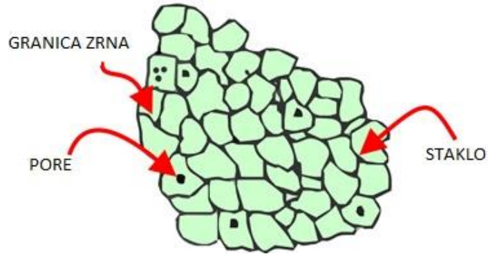
Sl. 3.2. Mikrostruktura keramike
