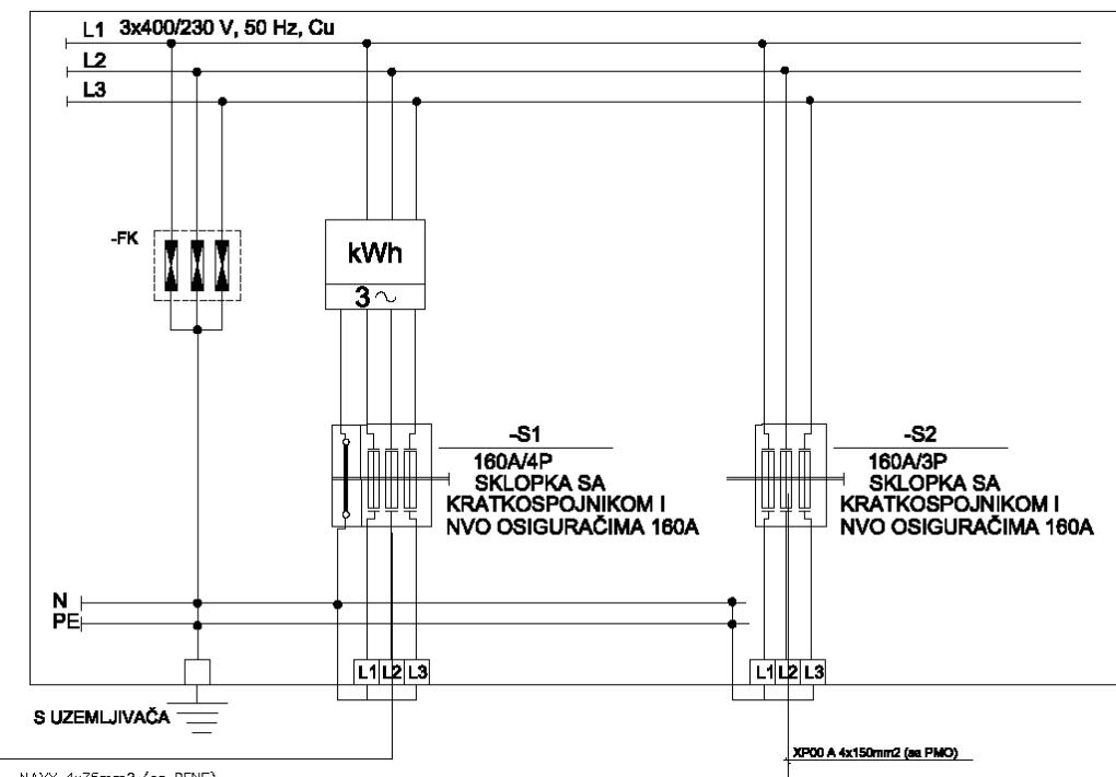
Slika 6.11. Primjer jednopolne sheme samostojećeg priključno mjernog ormarića SPMO-1 [34]
