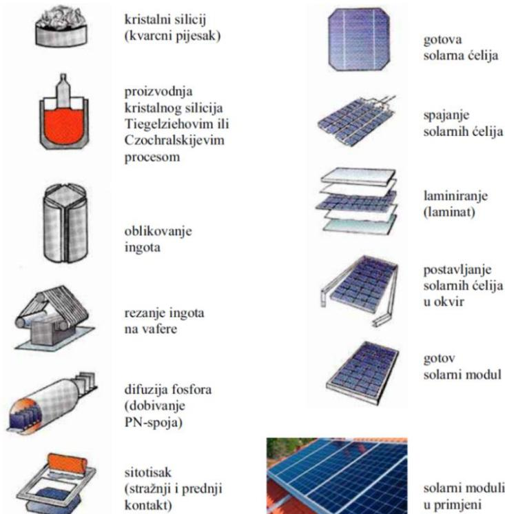
*Slika 3.6. Postupak proizvodnje čelija i fotonaponskih modula [13]*
