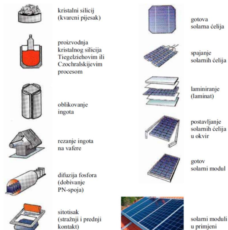
Slika 3.6. Postupak proizvodnje ćelija i fotonaponskih modula [13]
