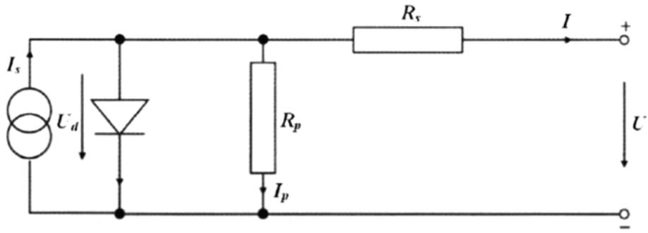
Slika 3.2. Nadomjesna shema fotonaponske čelije [15]
