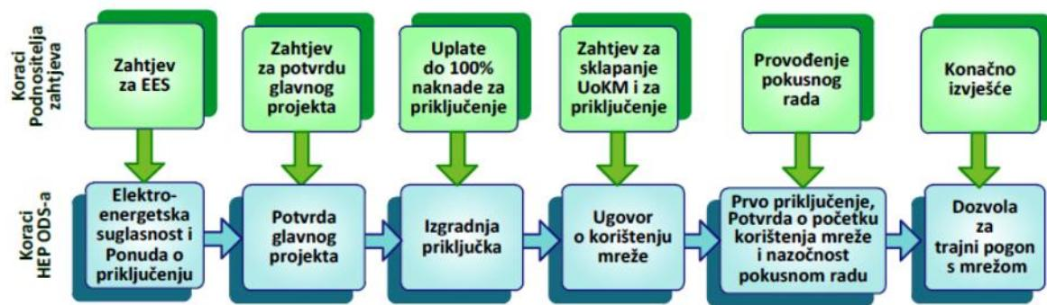
Slika 5.2. Pojednostavljeni priključak sunčane elektrane na mrežu HEP-ODS-a [25]
