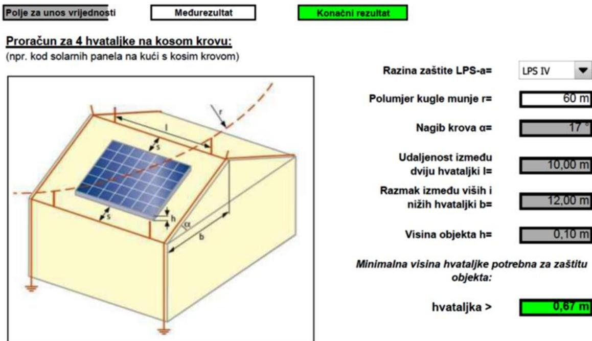
Slika 6.2. Određivanje visine hvataljke pomoću metode kugle munje [32]
