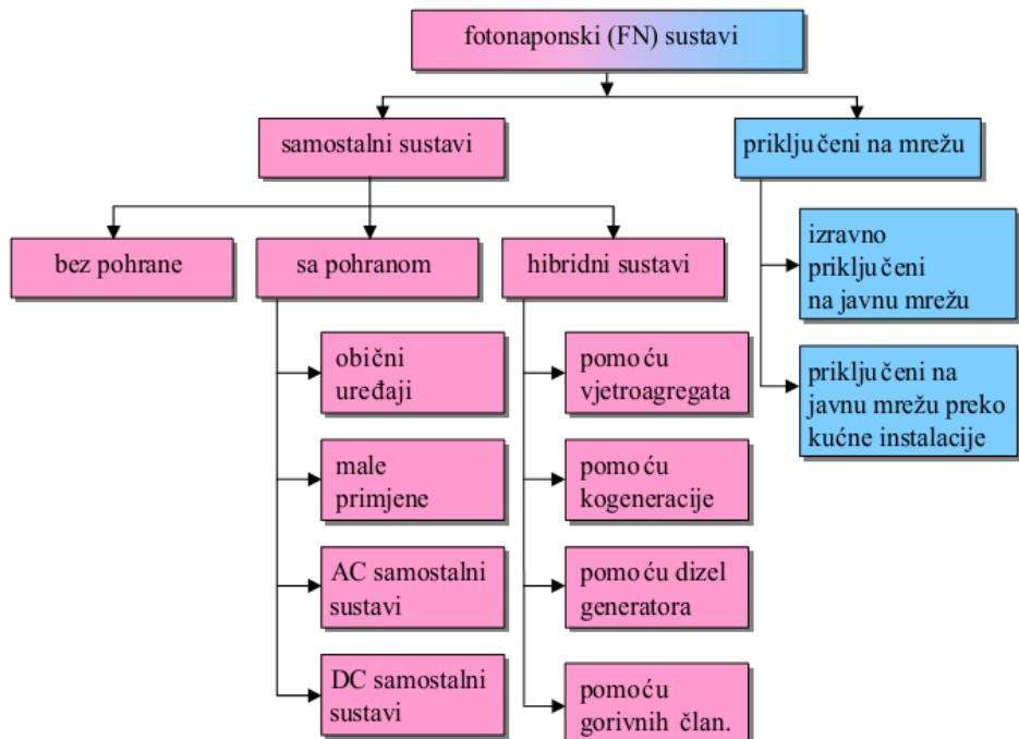
Slika 4.1. Podjela fotonaponskih sustava [13]
