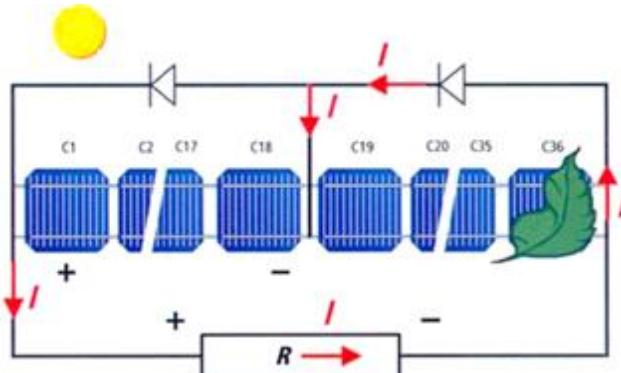
Slika 3.9. Paralelni spoj premosne diode [19]
