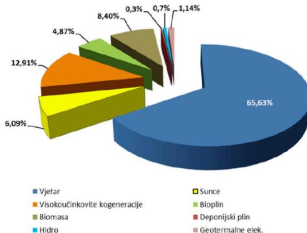
*Slika 2.6. Udio tipova postrojenja u ukupnoj instaliranoj snazi (MW) [15]*
