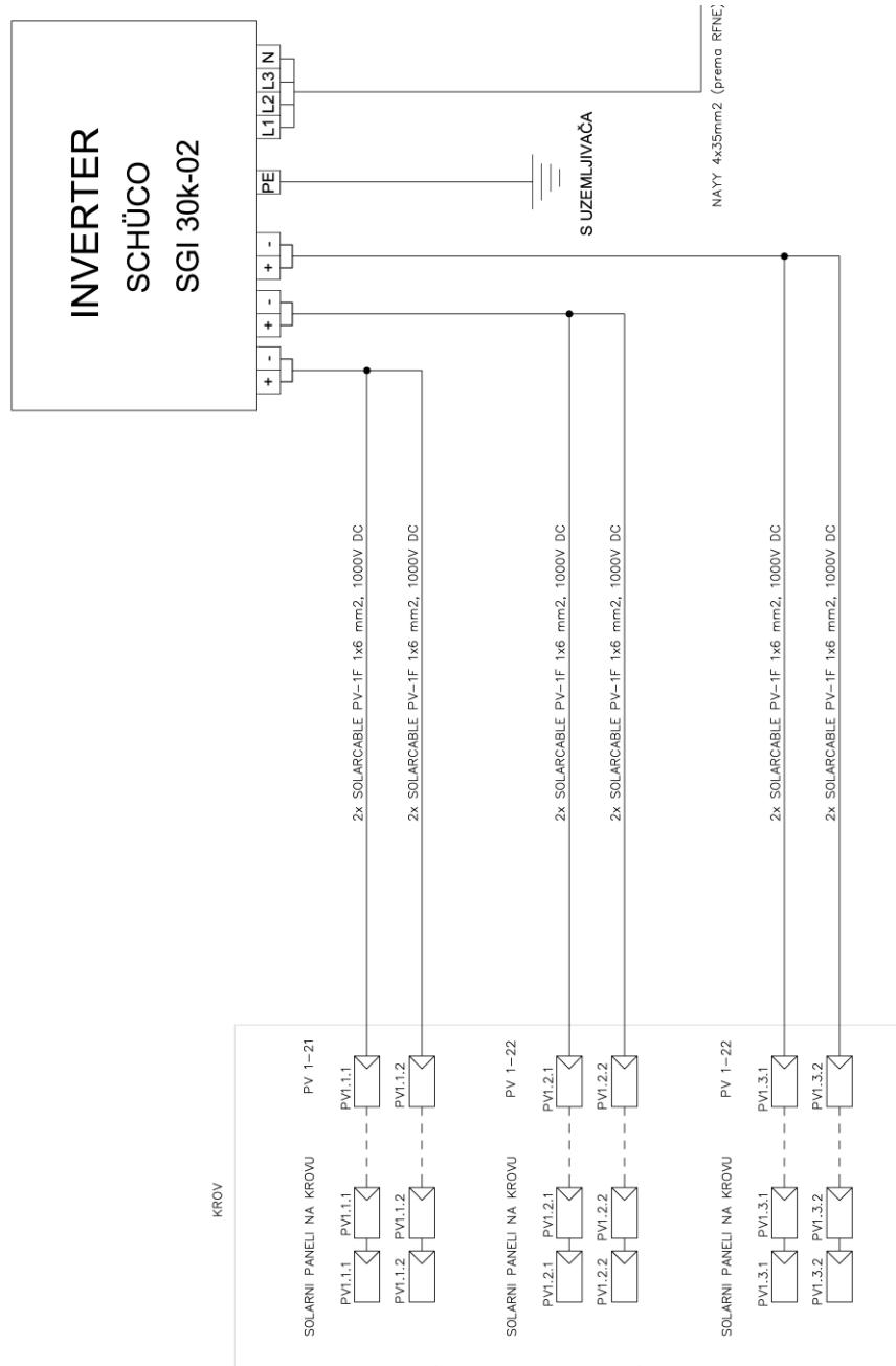
Slika 6.9. Primjer blok sheme fotonaponske elektrane [34]
