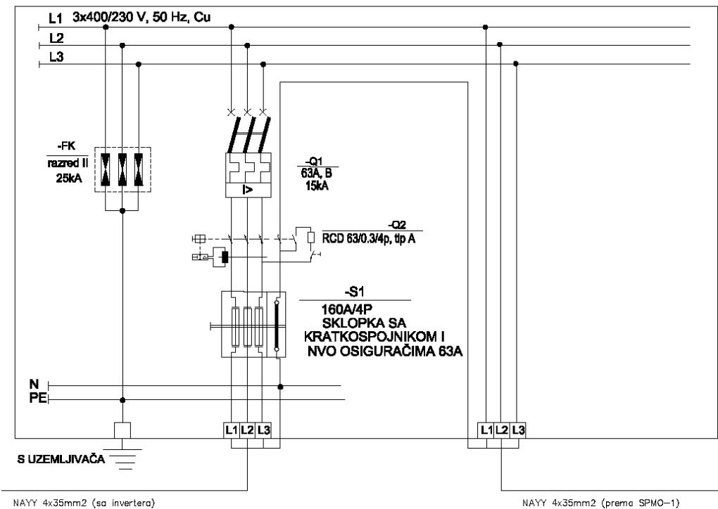
Slika 6.10. Primjer jednopolne sheme razvodnog ormara fotonaponske elektrane (RFNE) [34]
