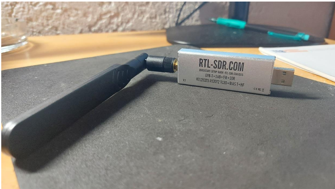
Slika 4.1. RTL-SDR uređaj s pripadajućom antenom
