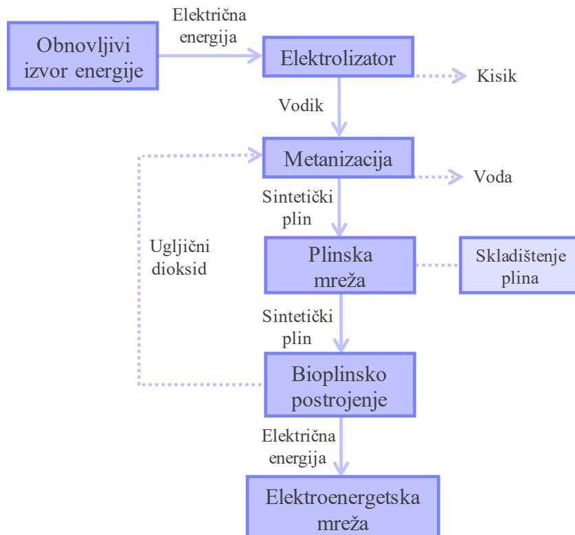
Sl. 3.10. Pohrana električne energije korištenjem sintetičkog plina [24]
