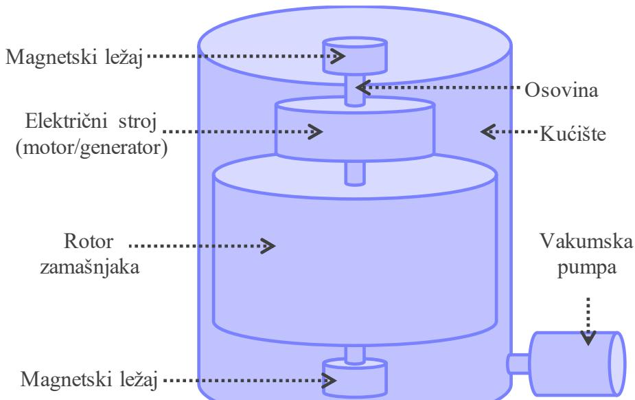
Sl. 3.2. Struktura i komponente energetskog zamašnjaka [7]
