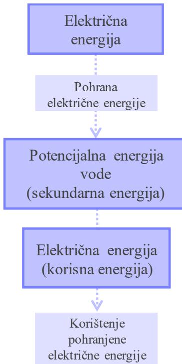
Sl. 2.2. Pohrana električne energije pomoću reverzibilne hidroelektrane [4]
