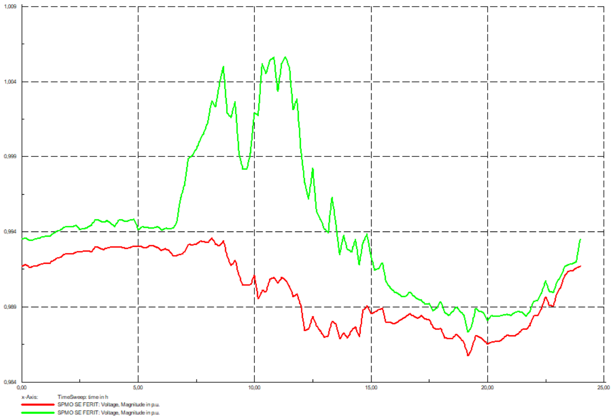
Slika 5.10. Promjena napona na sabirnici SPMO (c-prije integracije, z-nakon integracije)
