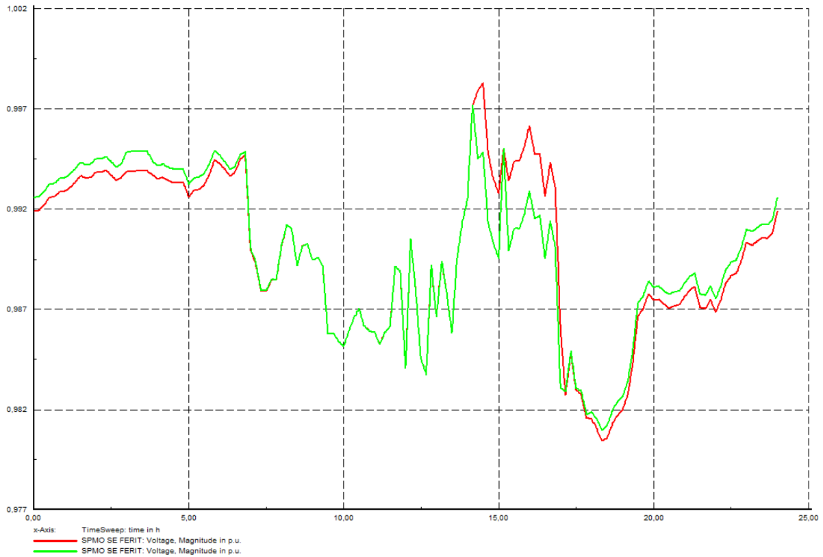
Slika 5.21. Promjena napona na sabirnici SPMO (c-bez baterije, z-s baterijom)
