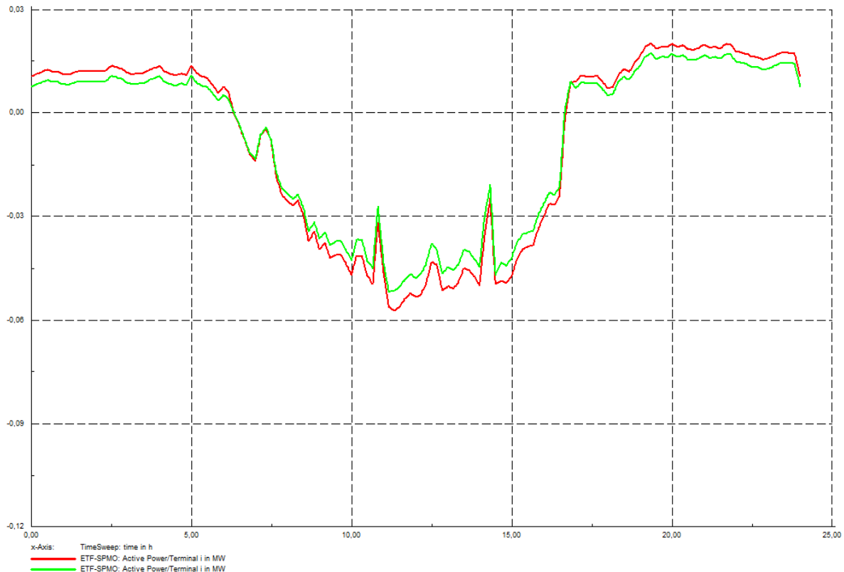
Slika 5.27. Promjena opterećenja kroz priključni vod (c-bez baterije, z-s baterijom)
