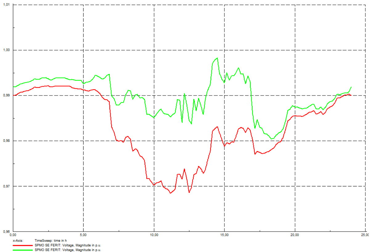
Slika 5.1. Promjena napona na sabirnici SPMO (c-prije integracije, z-nakon integracije)
