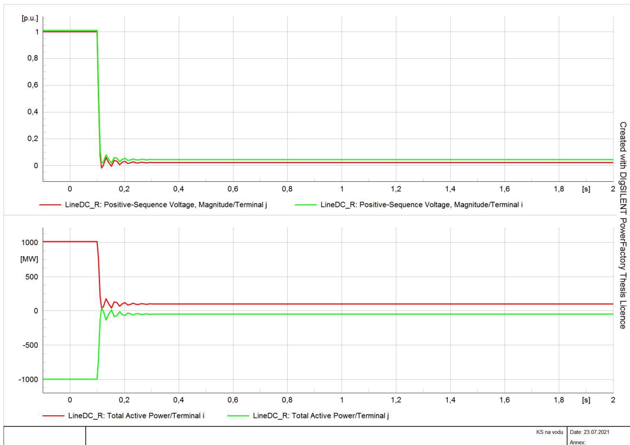
4-17 Napon i snaga na vodu prije i nakon kratkog spoja
