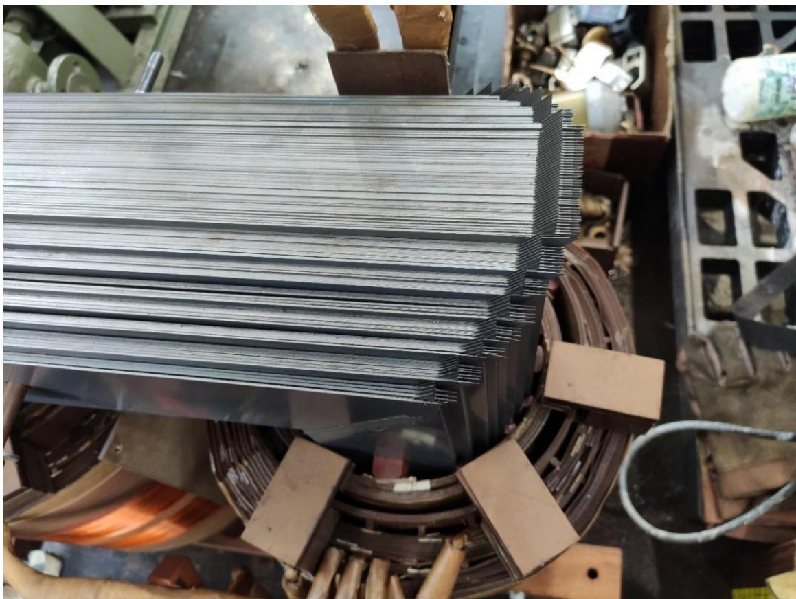
**Slika 3.10.** Jezgra transformatora izgrađena od transformatorskih limova
