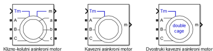
Sl. 3.8. Izvedbe rotora asinkronog motora
