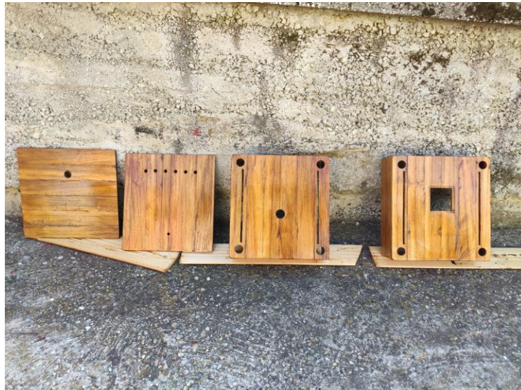
Slika 18. Prvi sloj lazure za hrast na drvenom dijelu kućišta
