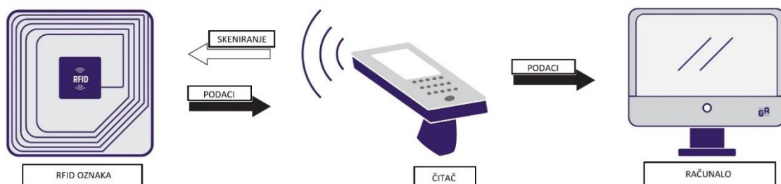
Slika 1. Primjer RFID sustava
