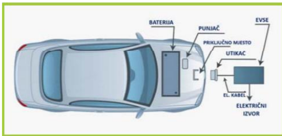
Slika 5.3. Sustav za punjenje električnog vozila [14]
