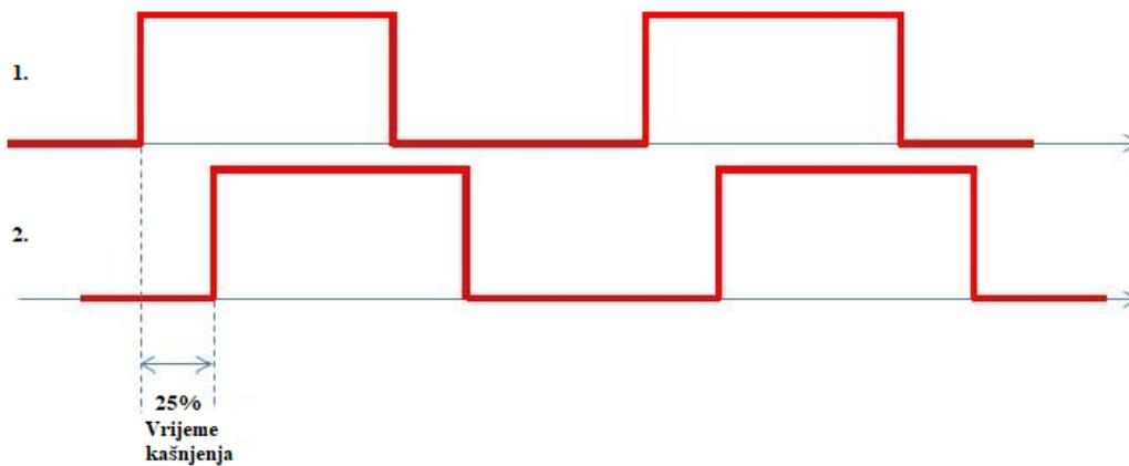
Sl. 3.3. Prikaz fazno ispravnog PWM-a s faznim pomakom i kašnjenjem od 25%.
