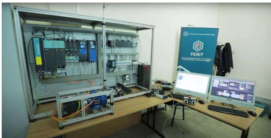
**SL. 5.21:** Ispitna stanica za ispitivanje asinkronih strojeva
