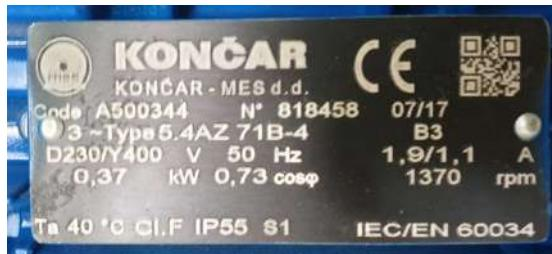
**SL. 2.9:** Natpisna pločica ispitivanog asinkronog stroja
