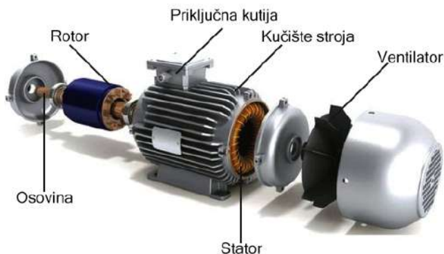
SL. 2.1: Konstrukcija asinkronog stroja [11]
