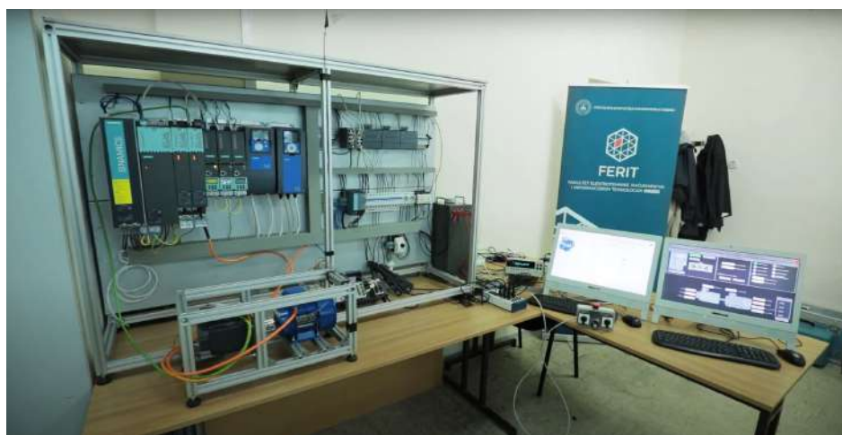
SL. 5.21: Ispitna stanica za ispitivanje asinkronih strojeva
