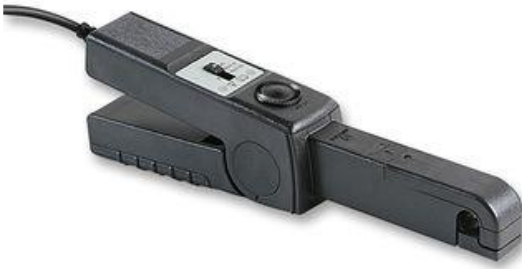
Slika 3.6. Strujna kliješta Tektronix A622.
