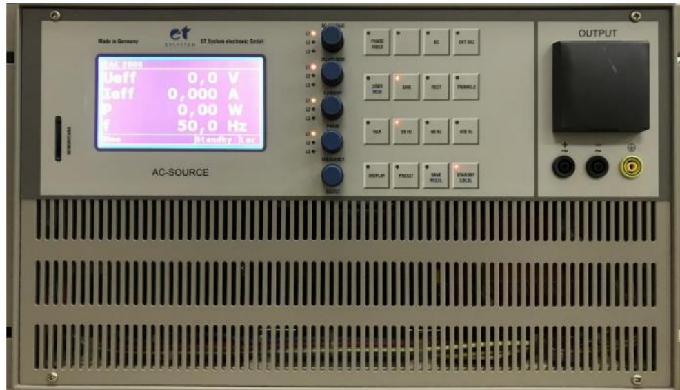
Slika 3.4. Izmjenični izvor ET System EAC-S2000.
