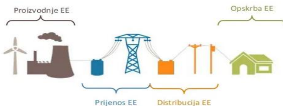
Slika 3.1. Prikaz elektroenergetskog sustava [19]
