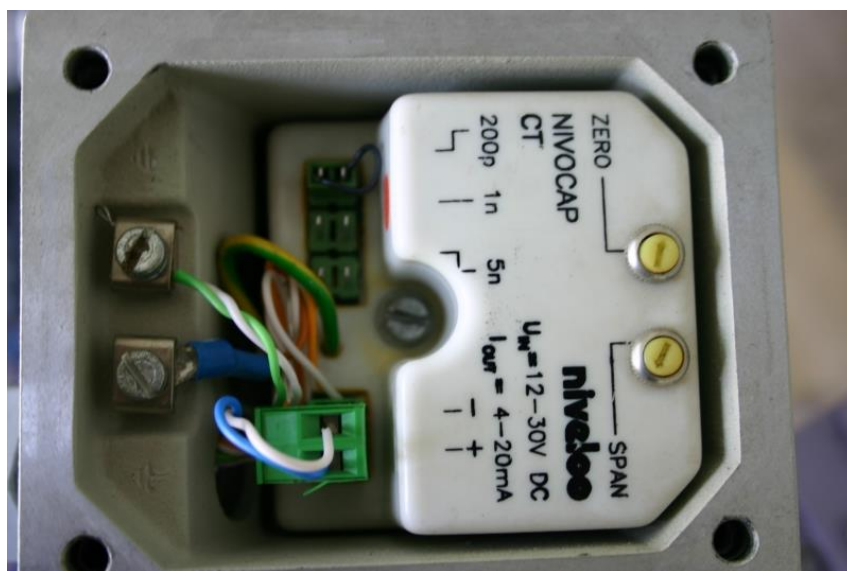
Slika P. 1.2. Unutrašnjost kućišta neispravnog mjernog člana.
