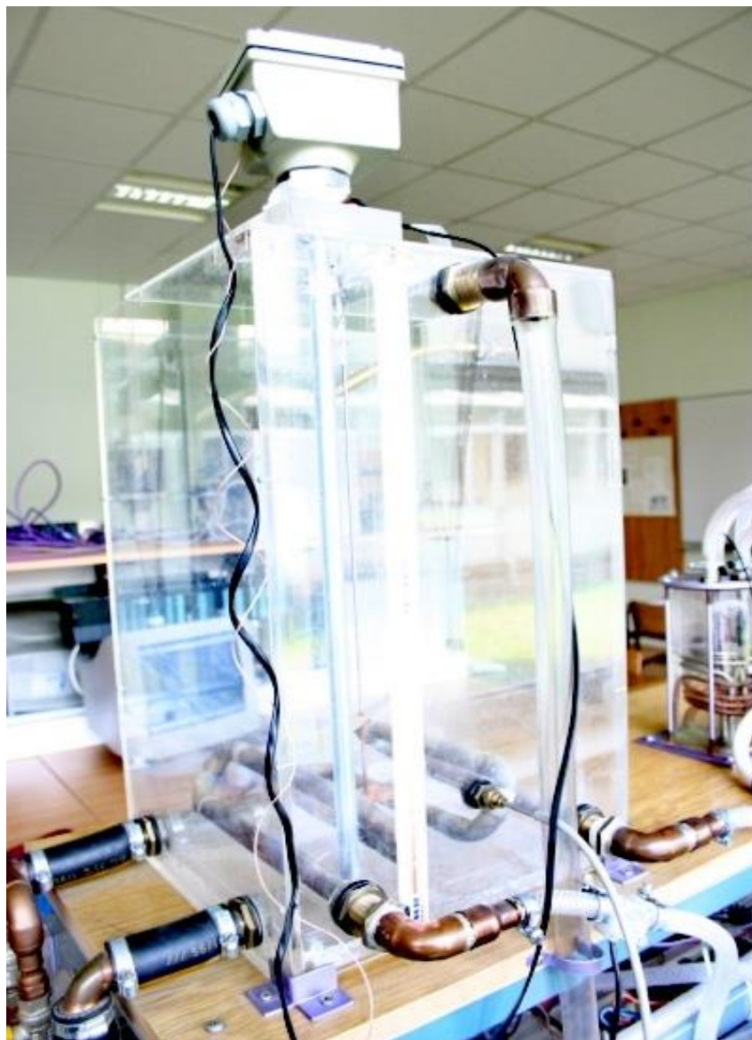
Slika P. 1.1. Spremnik za uskladištenje tekućine sa neispravnim mjernim članom.
