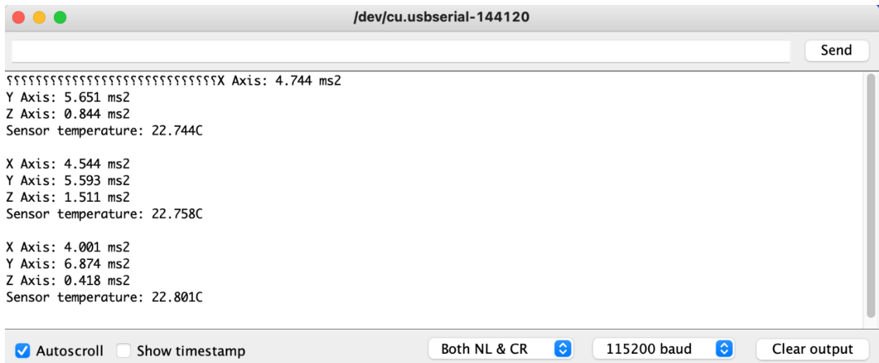
Slika 4.4. Rezultati testiranja akcelerometra.
