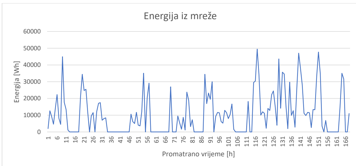
Slika 6.19. Dolazna energija iz mreže u istosmjernu mikromrežu
