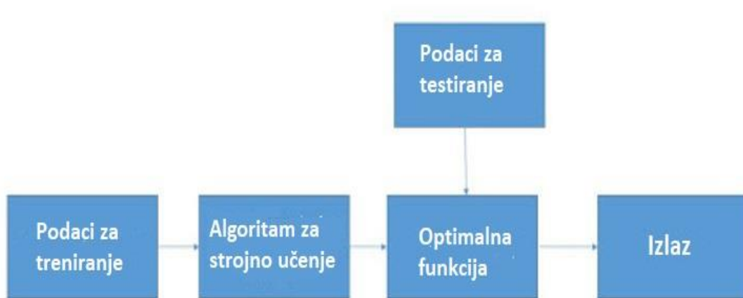
Slika 3.6. Princip rada strojnog učenja [14]
