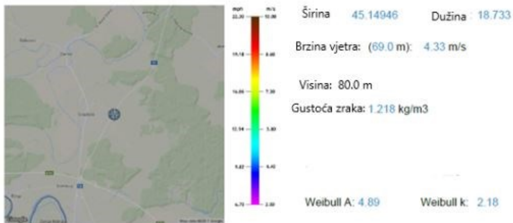
Slika 7: karakteristike srednje brzine vjetra na visini 60 m u mjestu Gradište [9]
