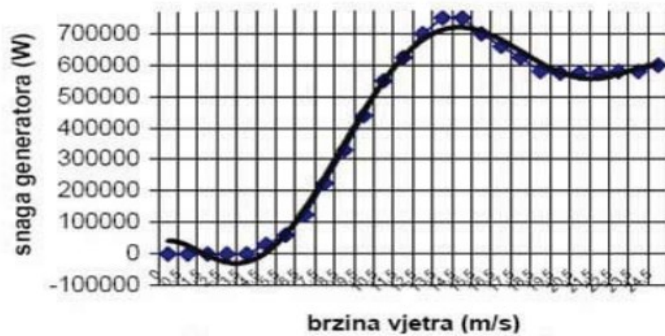
Slika 1: Ovisnost snage vjetrogeneratora o brzini vjetra [1]
