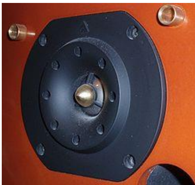
Slika 4.13: Visokotonski zvučnik pozicioniran u kutiji s kalotnom membranom
