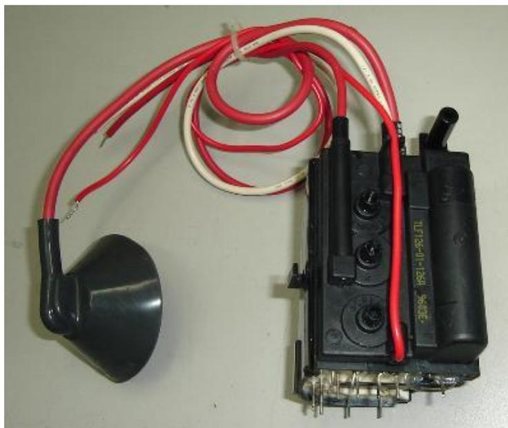
**Slika 7.1:** Visokofrekventni (flyback) transformator
