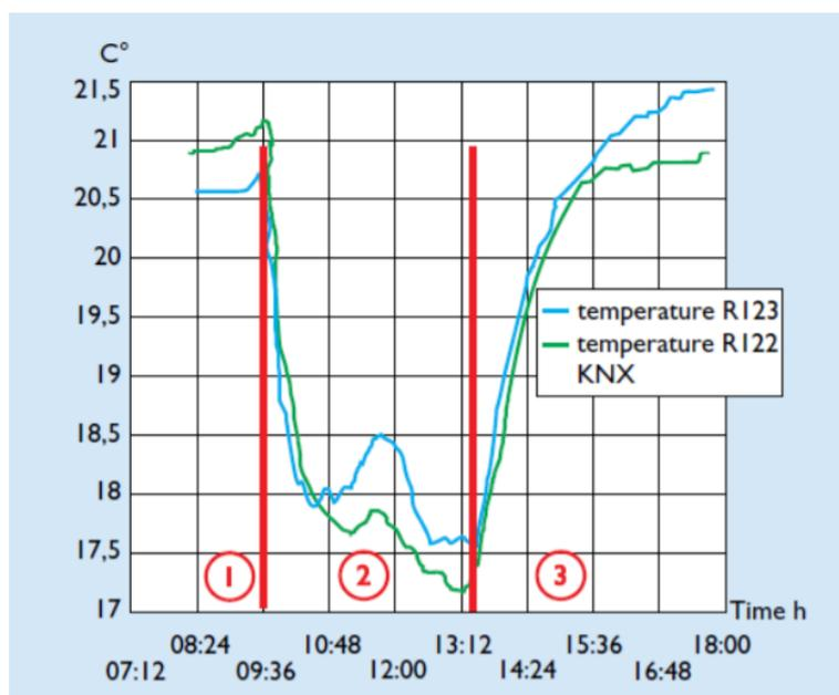
**Slika 7.14.** Grafički prikaz temperaturne promjene u sobi s tradicionalnom električnom instalacijom i istoj sobi sa naprednom električnom instalacijom [13]
