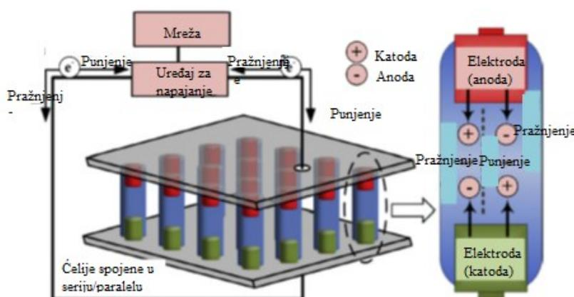
Slika 4.1. Shematski prikaz rada baterijskog spremnika energije, [10].
