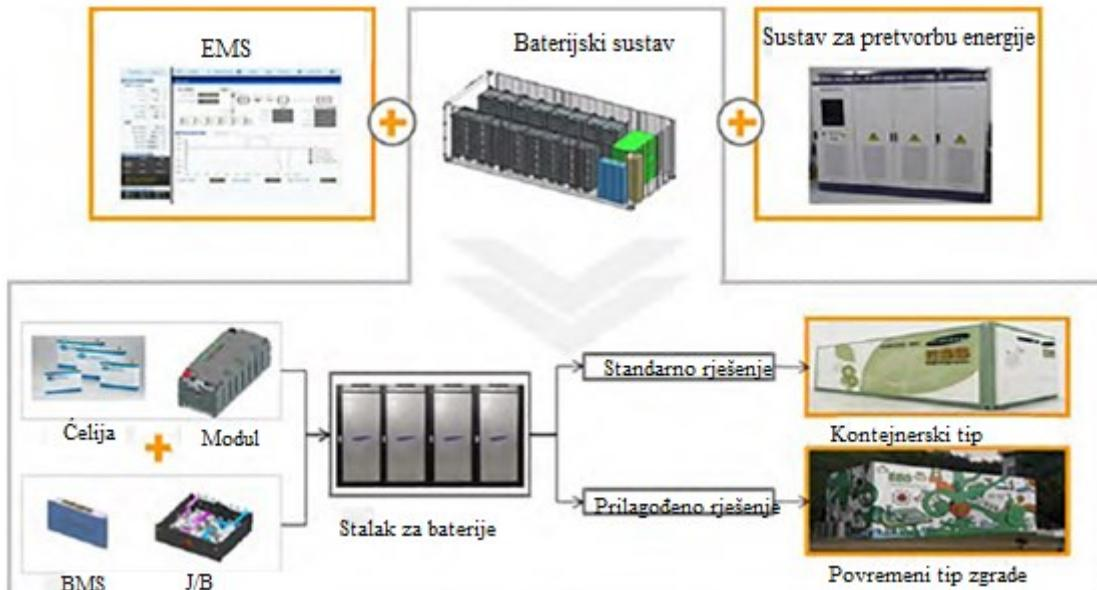
Slika 4.6. Shematski prikaz baterijskog sustava za pohranu energije, [11].
