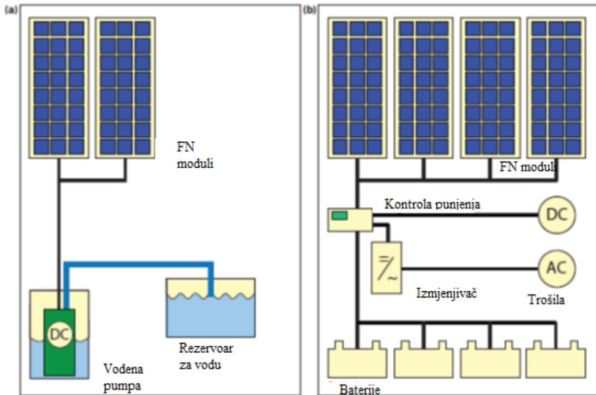
**Slika 2.4.** Shematski prikaz (a) jednostavnog FN sustava za napajanje vodene pumpe bez spremanja energije i (b) složenog FN sustava koji uključuje baterije, uređaje za napajanje, istosmjerna i izmjenična opterećenja, [4].
