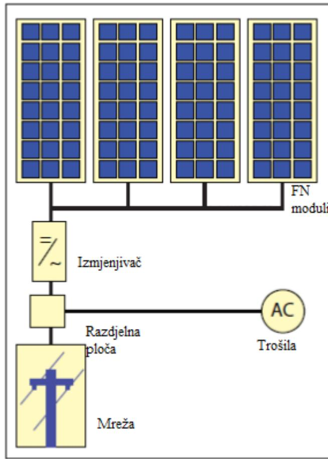
**Slika 2.2.** Shematski prikaz mrežnog FN sustava, [4].
