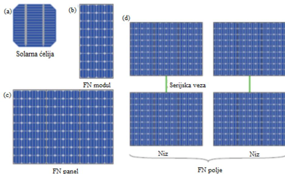
**Slika 2.9.** Ilustracijski prikaz (a) solarne čelije, (b) FN modula, (c) FN panela i (d) FN polja
