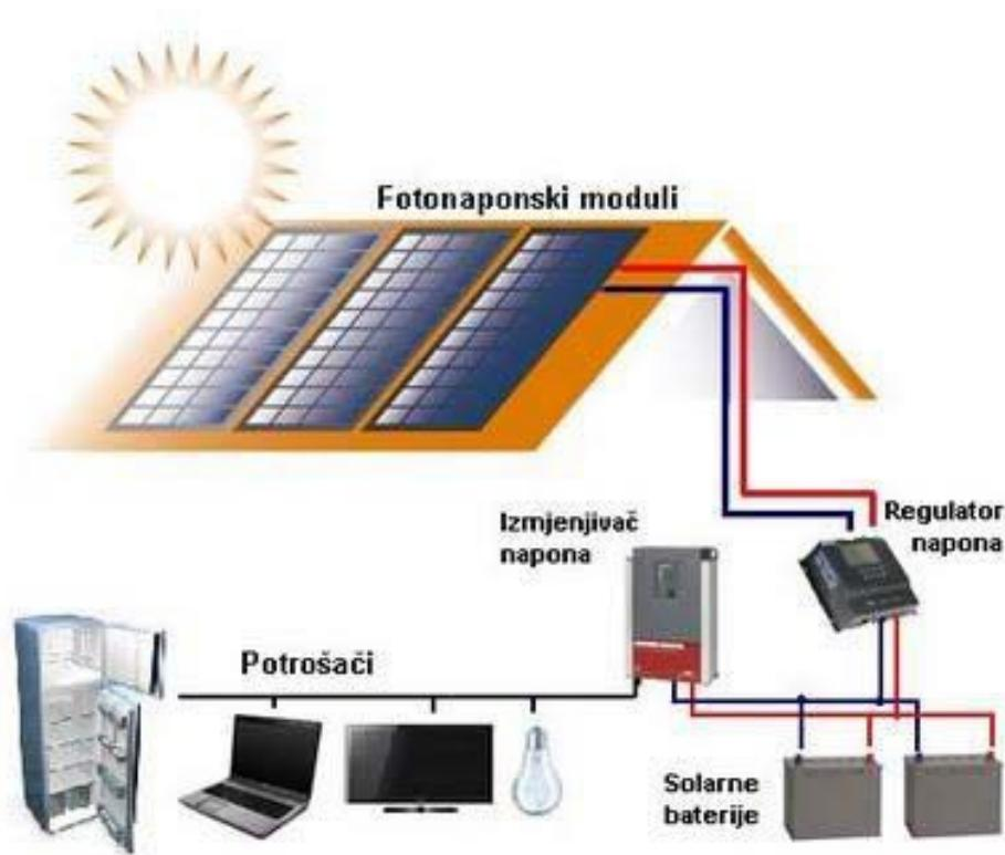
Slika 2.3. Samostalni fotonaponski sustav, [2].
