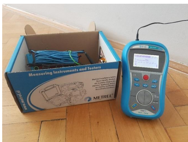
Slika 4.1. Mjerni instrument Metrel MI 3123
