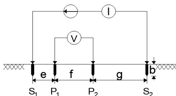
**Slika 2.6.3** Shema opće metode mjerjenja otpornosti tla [3]
