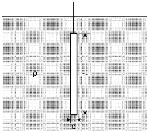
Slika 3.2.2. Štapni uzemljivač
