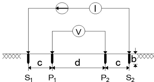
Slika 2.6.2. Shema Schlumberger-ova metode mjerjenja otpornosti tla [3]
