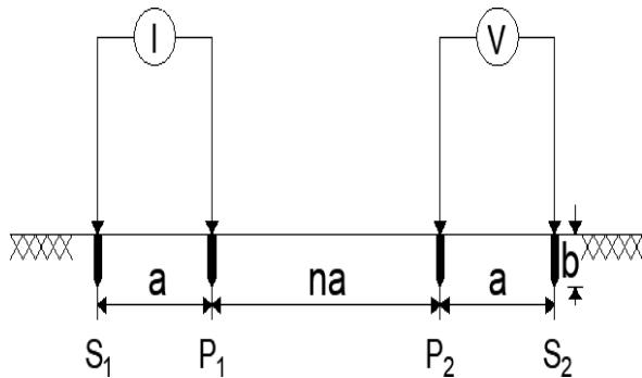
Slika 2.6.5. Shema za Dipol-Dipol metodu mjerjenja specifičnog otpora tla [3]
