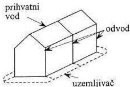
**Slika 3.1.3. Gromobransko uzemljenje [1]**
