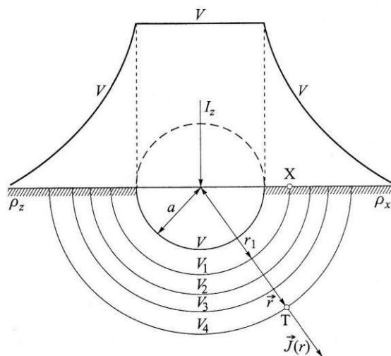
**Slika 3.2.1.** Razdioba potencijala za uzemljivač u obliku kugle [1]
