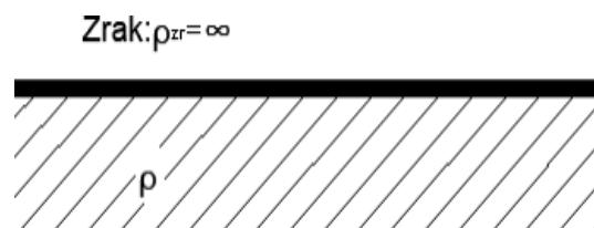
Slika 2.7.1. Model jednoslojnog tla [3]
