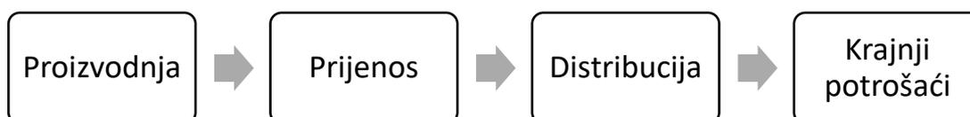
*Slika 3.1.* Dijelovi elektroenergetskog sustava
