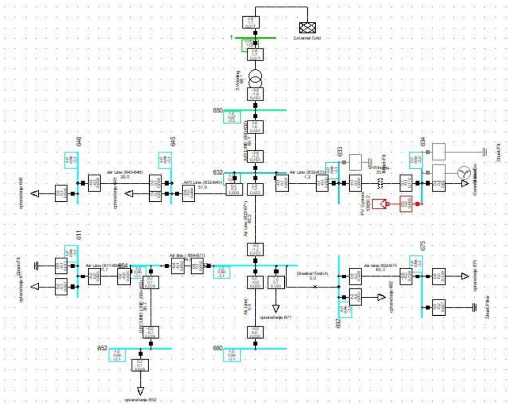
**Slika 6.17.** Tokovi snaga sa priključenim PV sustavom na sabirnicu 634
