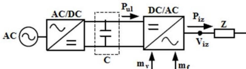
Slika 3.10. Povezivanje DG s izmjeničnim naponom [17]
