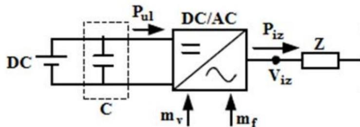
Slika 3.9. Povezivanje DG s istosmjernim naponom [17]
