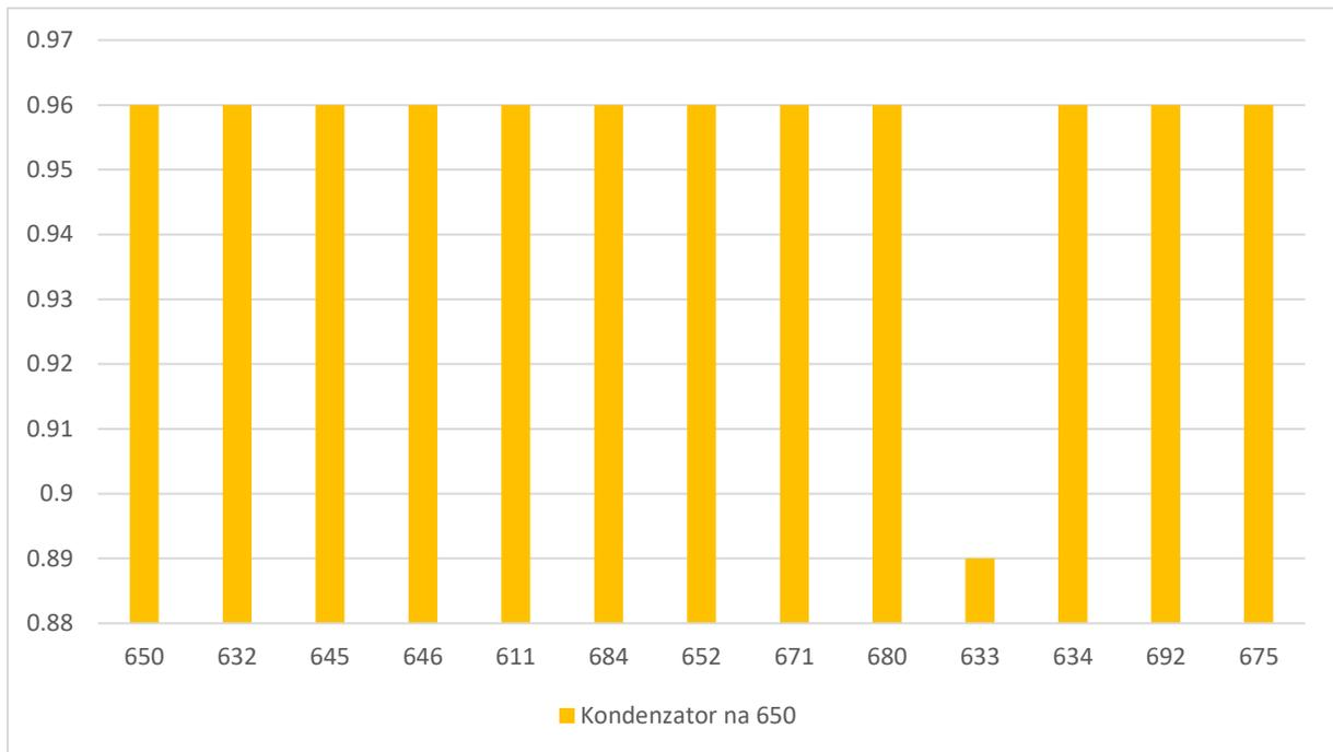
**Slika 6.27.** Naponi sabirnica nakon priključenog kondenzatora na 650
