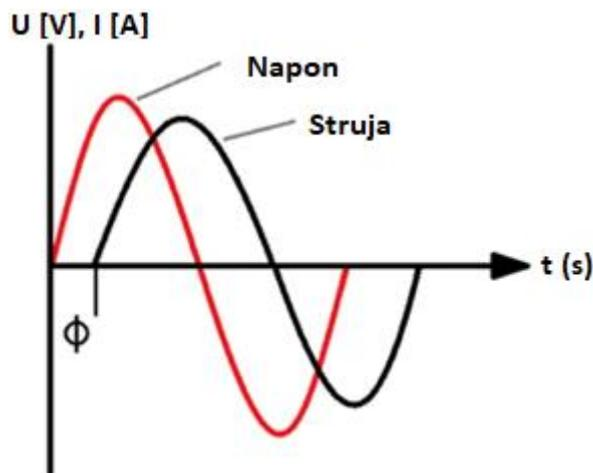
**Slika 4.2.** Dijagram napona i struja induktivnog trošila [6]
