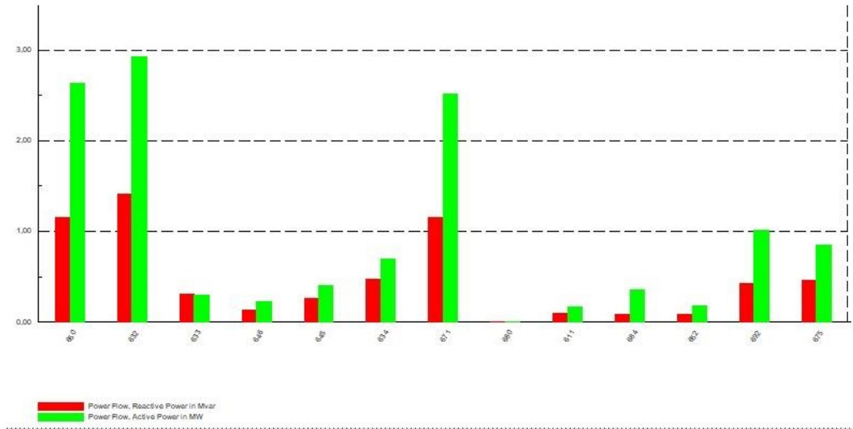
**Slika 6.22.** Opterećenja nakon priključenih elektrana i kondenzatorskih baterija
