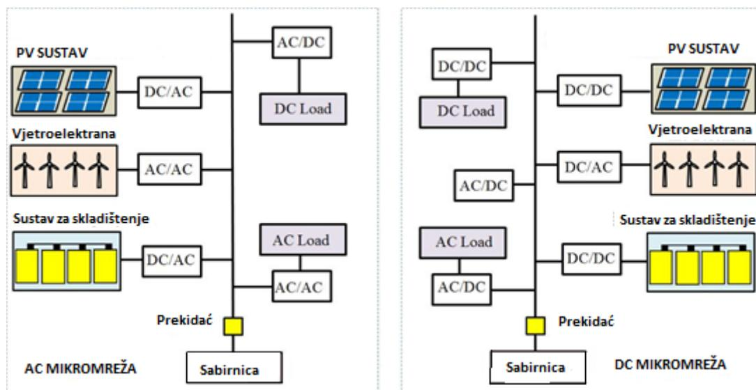
**Slika 3.8.** Izmjenična i istosmjerna mikromreža [3]
