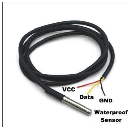
Slika 3.5. Prikaz DS18B20 senzora temperature prema izvoru [16]
