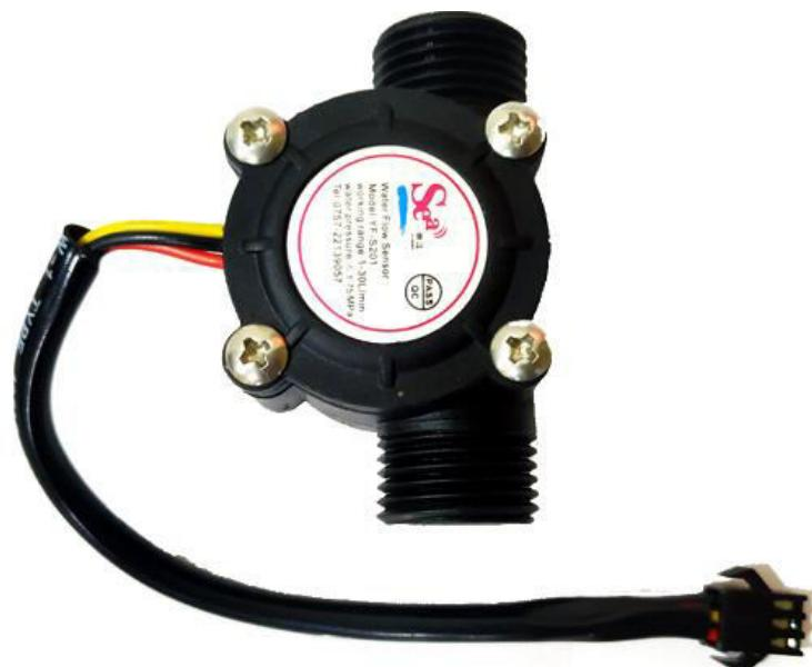
*Slika 3.7. Prikaz YF-S201B senzora protoka vode prema izvoru [17]*
