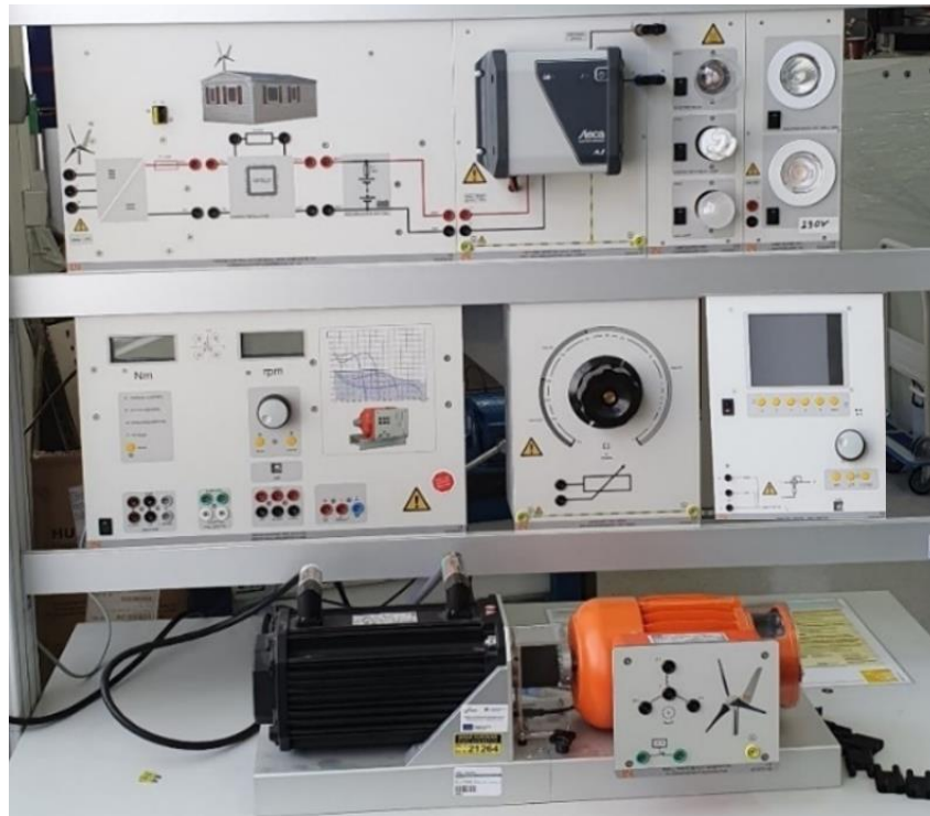
Sl. 2.1. Simulator male vjetroelektrane
