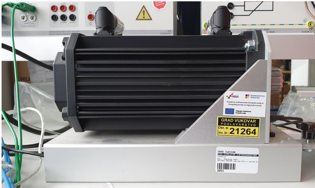
Sl. 2.9. Dinamički sustav ispitivanja servo strojeva (turbina)
