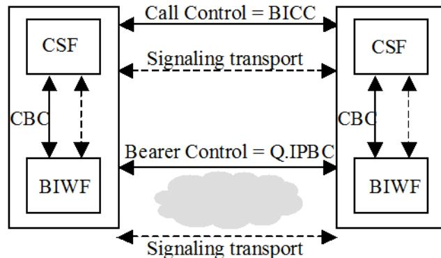
Slika 11. Mehanizam tuneliranja [10]
