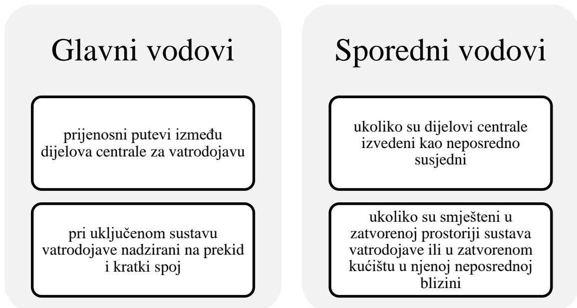
Slika 4.13. Vrste vodova kod sustava za dojavu požara [5, 7]
