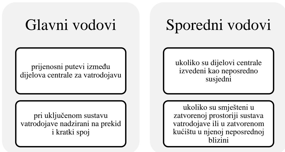
**Slika 4.13.** Vrste vodova kod sustava za dojavu požara [5, 7]
