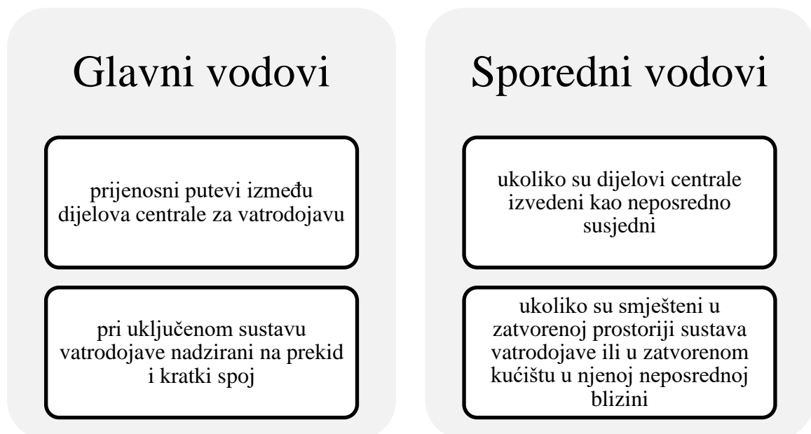
Slika 4.13. Vrste vodova kod sustava za dojavu požara [5, 7]
