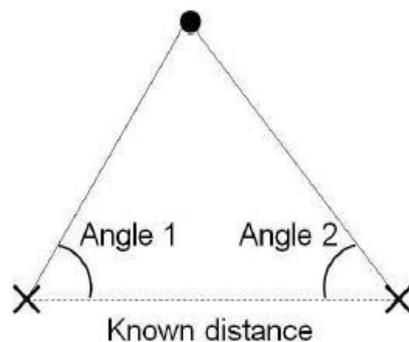
*Slika 11. Princip triangulacije [11]*
