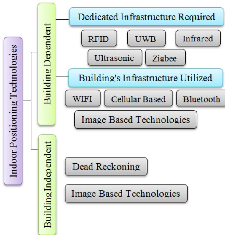
Slika 11. Podjela tehnologija za pozicioniranje u zatvorenom [16]
