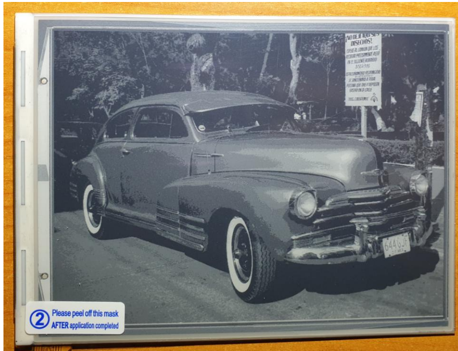
Slika 4.23. Slika u nijansama sive boje koristeći ESP32 mikroupravljač (8 razina sive boje) (slika preuzeta s [39])
