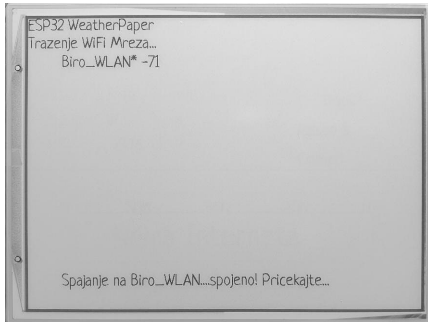
Slika 5.3. Spajanje unutrašnje jedinice na WiFi mrežu
