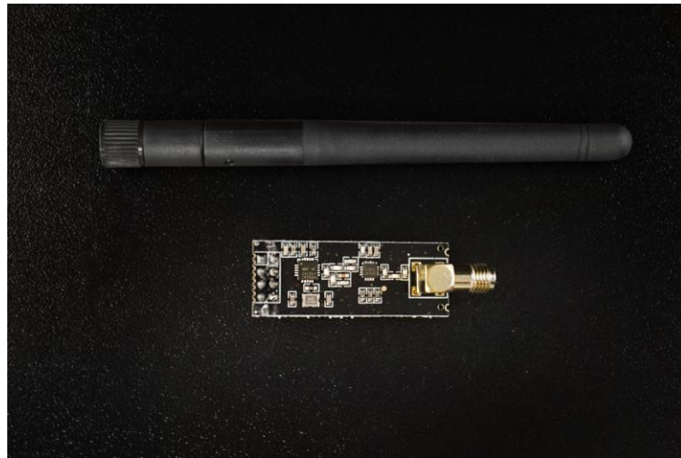
Slika 3.25. nRF24101 RF modul s pojačalom i antenom [31]
