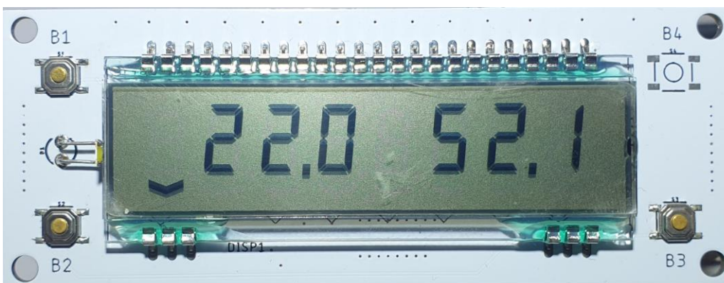
Slika 5.18. Prikaz trenutnog mjerenja (temperatura i vlaga zraka)
