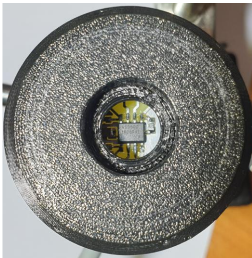
Slika 4.46. Integrirani krug u sredini osovine (za ispravnu detekciju)
