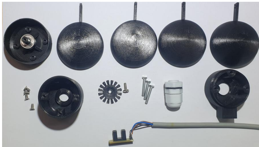
Slika 4.39. Dijelovi senzora brzine vjetra (anemometra)
