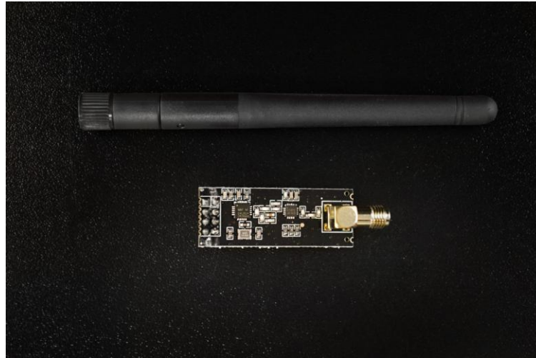
Slika 3.25. nRF24101 RF modul s pojačalom i antenom [31]
