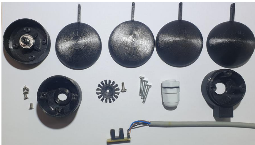
Slika 4.39. Dijelovi senzora brzine vjetra (anemometra)
