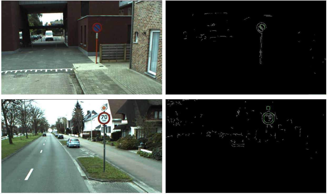
Slika 4.3. Primjeri slika s pogrešnim detekcijama krugova a) ulazna slika, b) izlazna slika sa zeleno označenim pogrešno detektiranim krugovima
