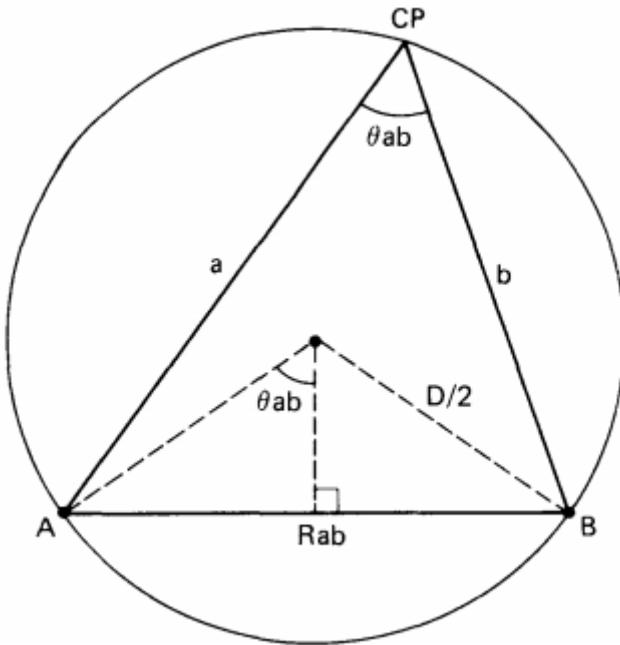
Slika 3.4. Određivanje parametara kruga iz tri točke
