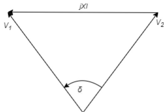
**Slika 2.1.** Dva izmjenična sustava povezana prijenosnim vodom i pripadajući fazorski dijagram [4]
