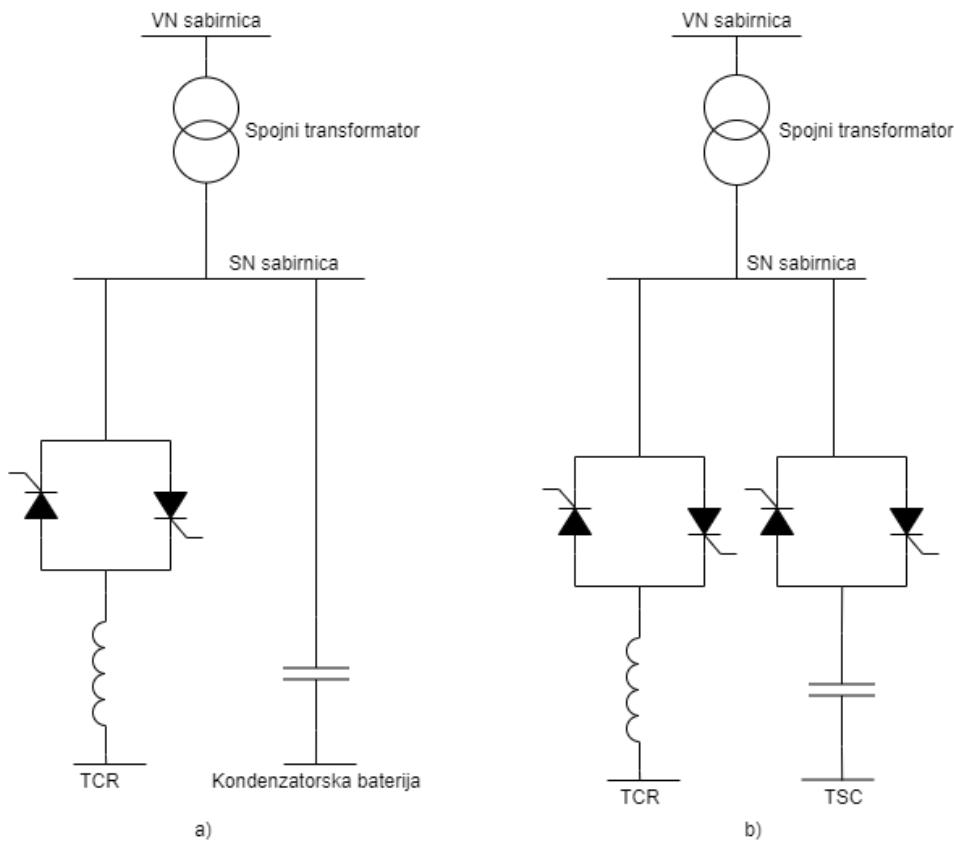
**Slika 3.2.** Shematski prikaz a) tiristorski upravljane prigušnice s nepromjenjivim kondenzatorom (FC – TCR) i b) tiristorski upravljana prigušnica s tiristorski uklopivim kondenzatorom (TSC - TCR) [4]
