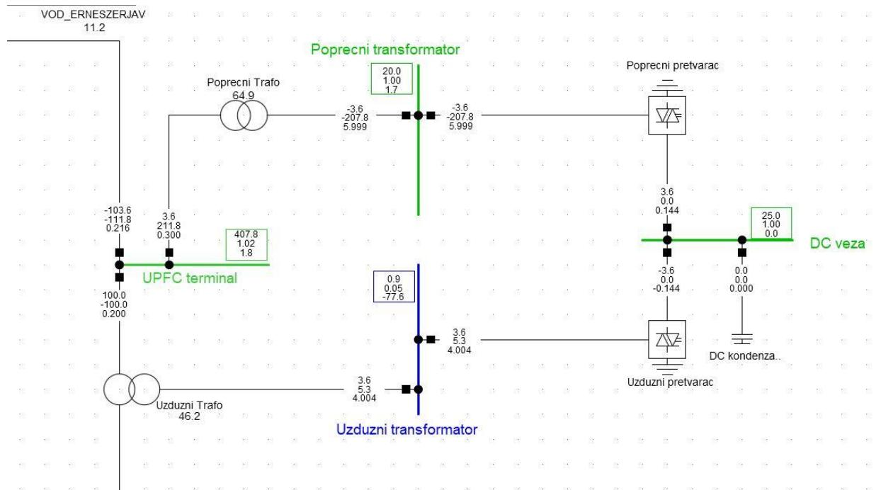
**Slika 4.6.** UPFC uređaj za slučaj kompenzacije s +100MW djelatne i -100MVAr jalove snage
